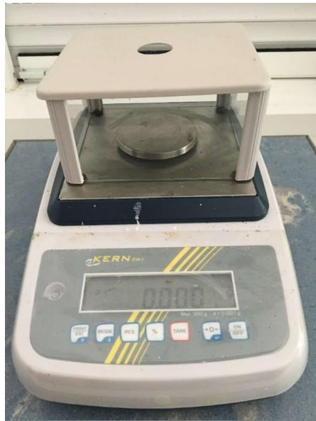
Slika 6. Analitička vaga ( KERN, Njemačka )
