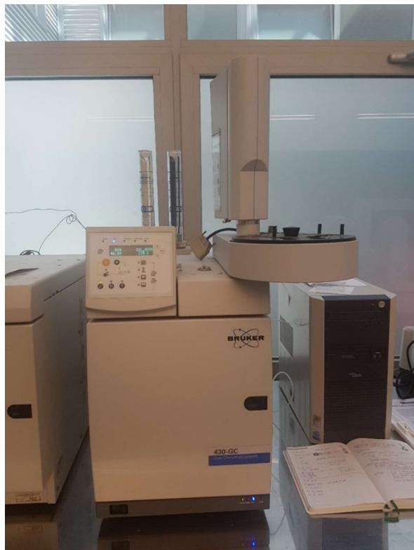
Slika 8 : Plinski kromatogarf (Burker 430)
