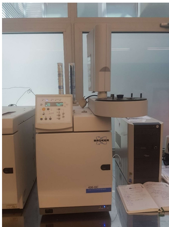
Slika 8 : Plinski kromatograf (Burker 430)
