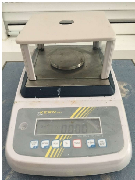
Slika 6. Analitička vaga ( KERN, Njemačka )
