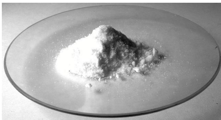
Slika 2.2.3. Kristali cinkova(II) nitrata heksahidrata, Zn(NO_3)_2 \cdot 6H_2O
