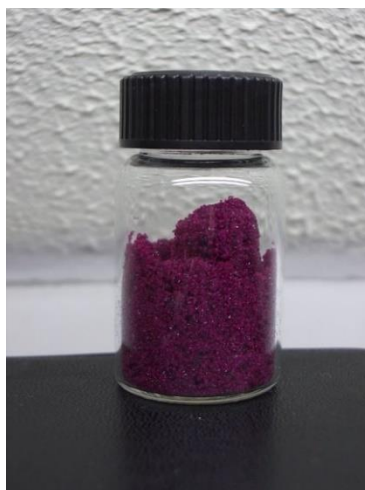
Slika 2.2.1. Kristali kobaltova(II) klorida heksahidrata, \text{CoCl}_2 \cdot 6\text{H}_2\text{O}
