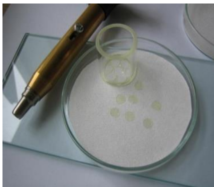
Slika 4. Izrada membrana tenzidno-selektivne elektrode [3]
