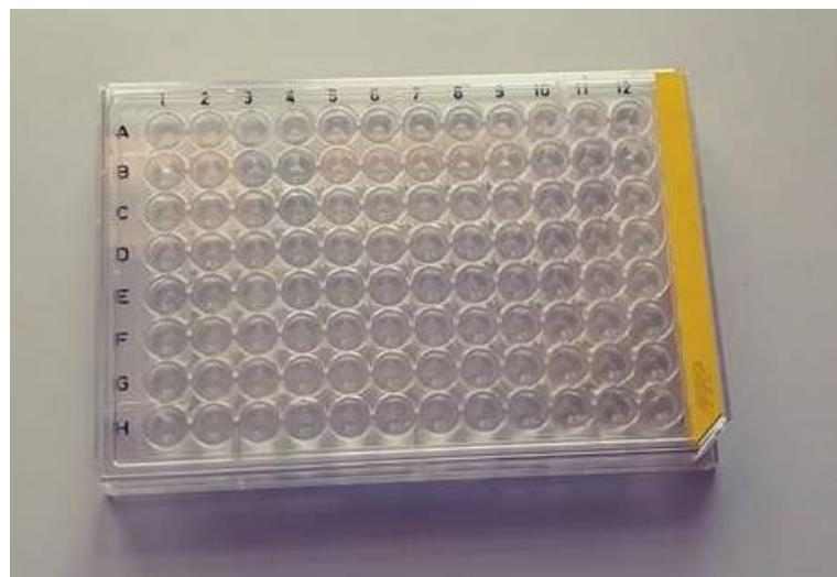
**Slika 12.** Pločica s jažicama u koju se stavlja uzorak i otapalo te se stavlja u uređaj za mjerjenje fluorescencije.
