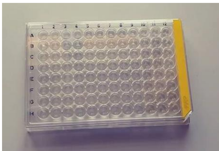
Slika 12. Pločica s jažicama u koju se stavljaju uzorak i otapalo te se stavlja u uređaj za mjerenje fluorescencije.
