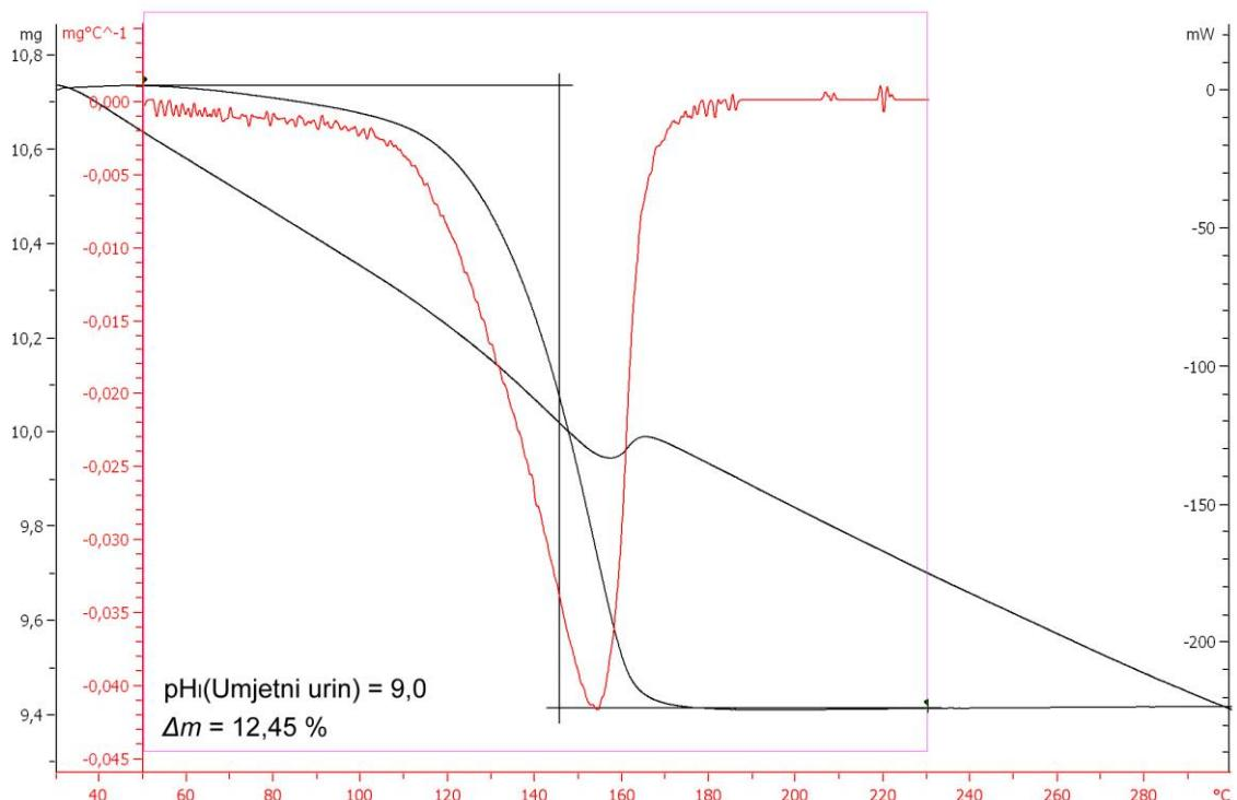
**Slika 30.** Termogram promatranog sustava  $c_i(\text{Ca}^{2+}) = 7,5 \text{ mmol dm}^{-3}$  i  $c_i(\text{C}_2\text{O}_4^{2-}) = 6,0 \text{ mmol dm}^{-3}$  pri  $\text{pH}_i = 9,0$  – termogravimetrijska krivulja označena crnom, prva derivacija crvenom bojom, dok  $\Delta m$  označava eksperimentalnu vrijednost
