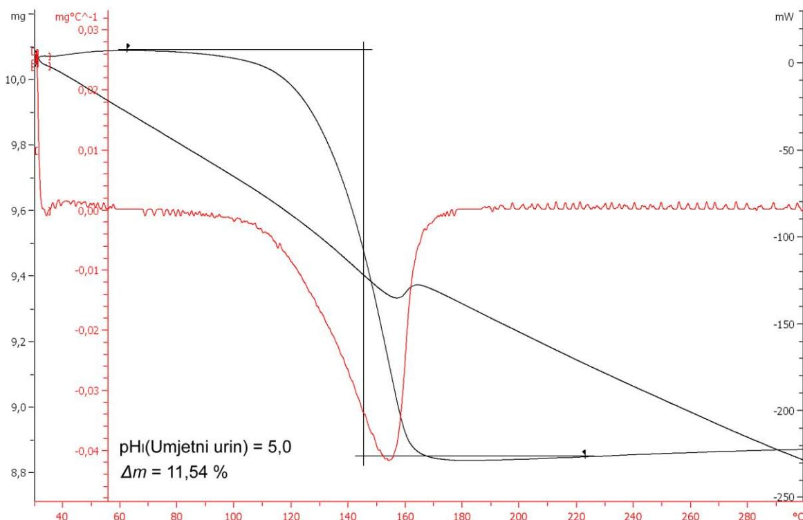
**Slika 25.** Termogram promatranog sustava  $c_i(\text{Ca}^{2+}) = 7,5 \text{ mmol dm}^{-3}$  i  $c_i(\text{C}_2\text{O}_4^{2-}) = 6,0 \text{ mmol dm}^{-3}$  pri  $\text{pH}_i = 5,0$  – termogravimetrijska krivulja označena crnom, prva derivacija crvenom bojom, dok  $\Delta m$  označava eksperimentalnu vrijednost
