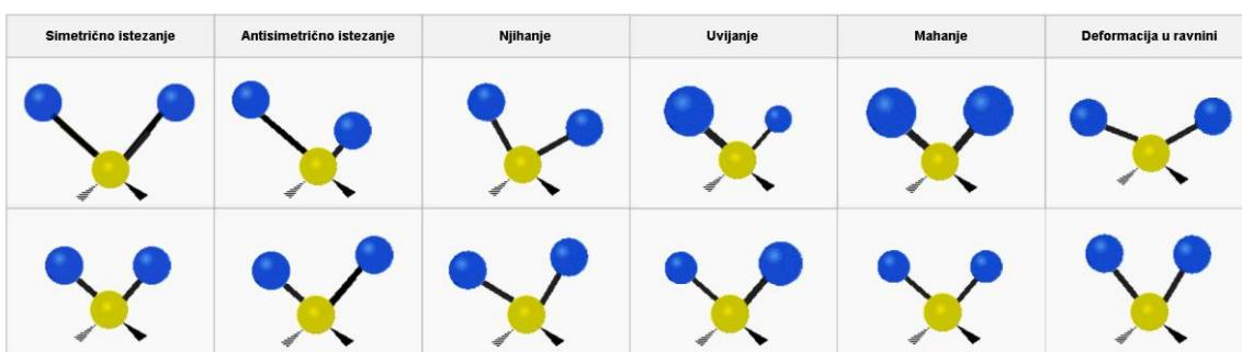
**Slika 20.** Shematski prikaz vibracija molekula
