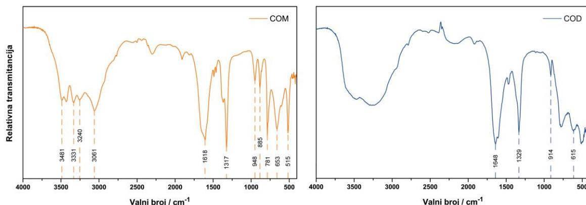
**Slika 37.** FT-IR standardi za COM i COD s karakterističnim vibracijskim vrpcamu
