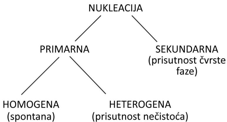
**Slika 2.** Shema mogućih mehanizama nukleacije po Mullinu [13].
