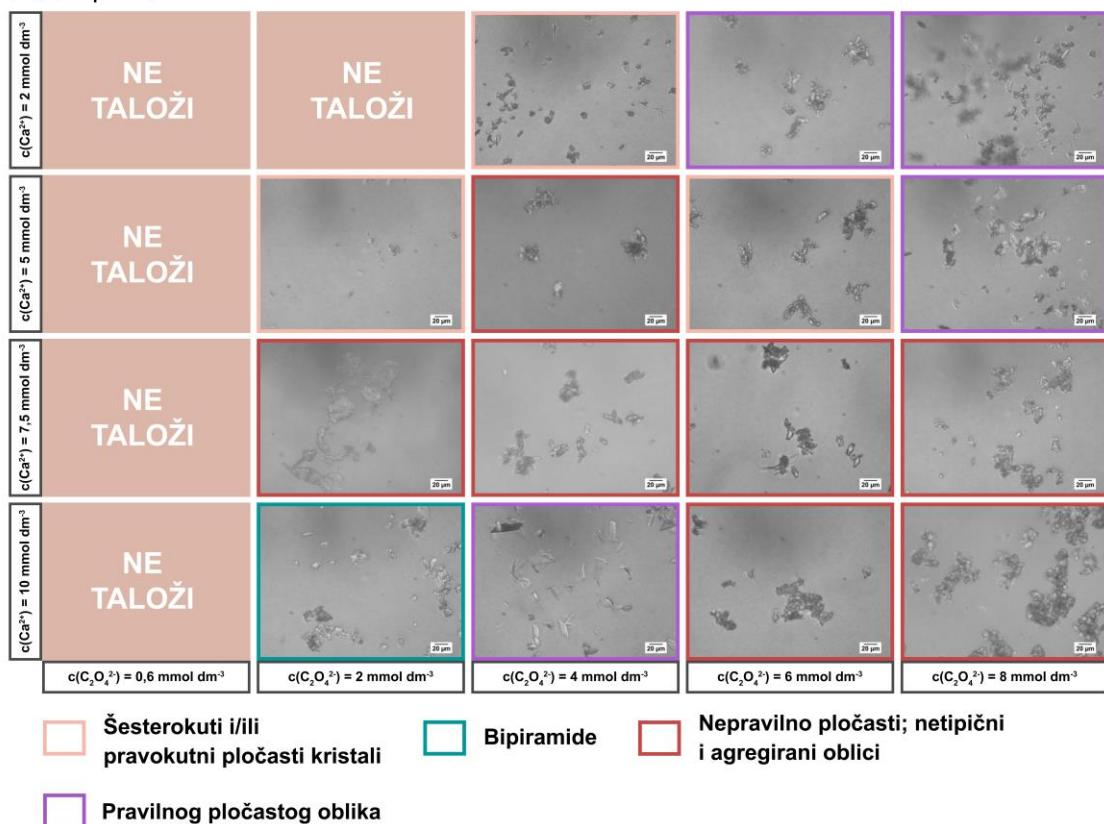
**Slika 33.** Morfologija kristala istaloženih u sustavu umjetnog urina u koncentracijskom području  $2,0 \text{ mmol dm}^{-3} \leq c_i(\text{Ca}^{2+}) \leq 10,0 \text{ mmol dm}^{-3}$  te  $0,6 \text{ mmol dm}^{-3} \leq c_i(\text{C}_2\text{O}_4^{2-}) \leq 8,0 \text{ mmol dm}^{-3}$  pri  $\text{pH}_i = 9,0$  – povećanje: 25x; prikazana skala odgovara veličini od  $20 \mu\text{m}$
