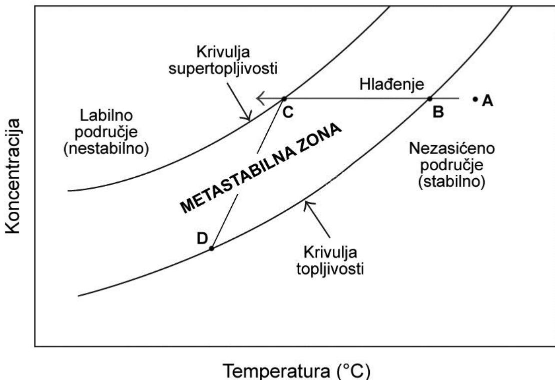
**Slika 5.** Pojednostavljeni prikaz dijagrama s metastabilnom zonom te krivuljama topljivosti i supertopljivosti
