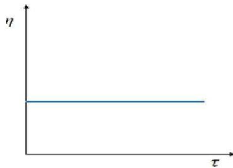
Slika 3. Krivulja viskoznosti Newtonovog fluida [5]
