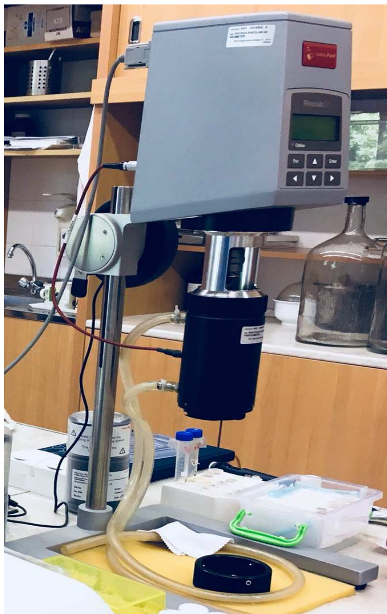
Slika 15. Rotacijski reometar Anton Paar RheolabQC
