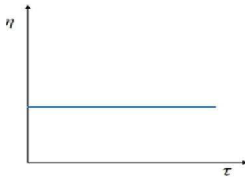
Slika 3. Krivulja viskoznosti Newtonovog fluida [5]
