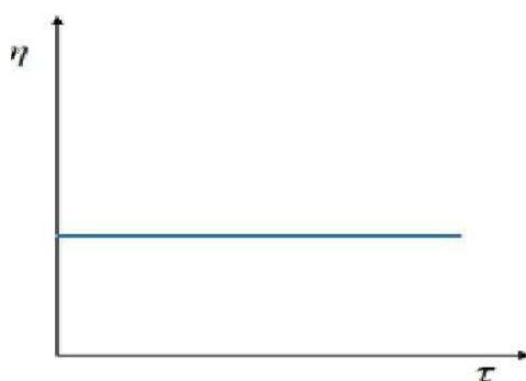
Slika 3. Krivulja viskoznosti Newtonovog fluida [5]
