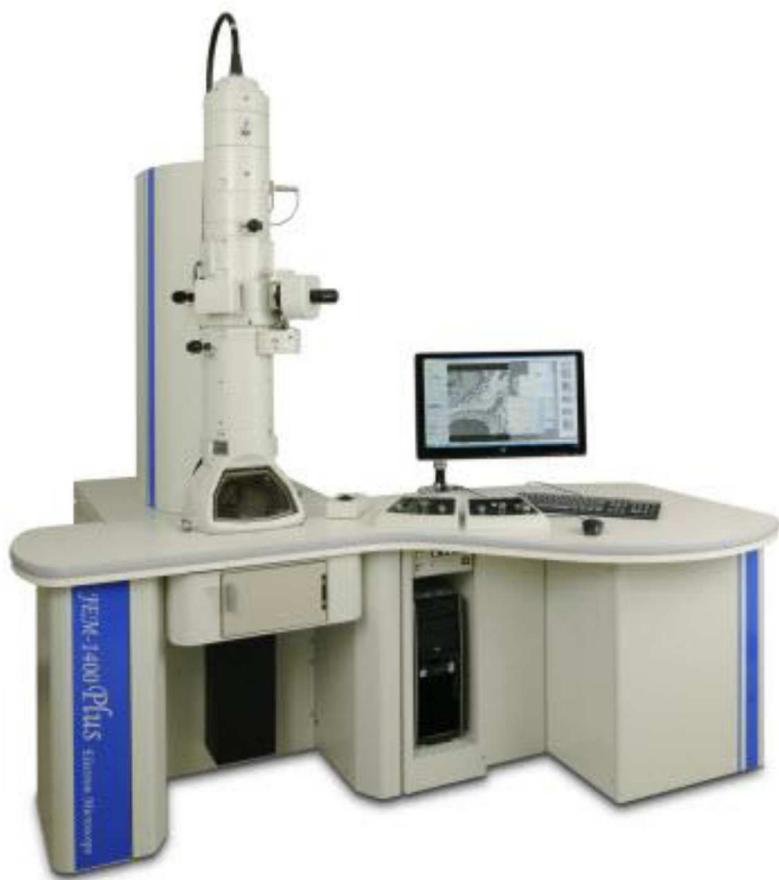
Slika 17. Transmisijski elektronski mikroskop [30]
