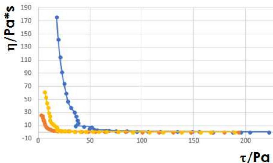
Slika 21. Grafički prikaz opadanja viskoznosti nakon tri uzastopna mjerena u razmaku od 15 min (žuta krivulja) i 20 min (crvena krivulja) od početnog mjerena (plava krivulja)
