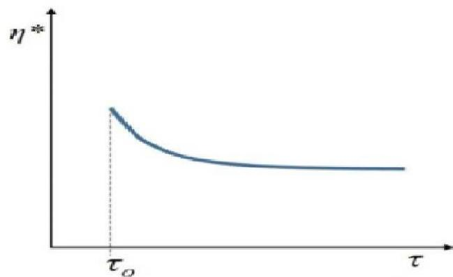
Slika 5. Krivulja viskoznosti ne-Newtonovog fluida [5]
