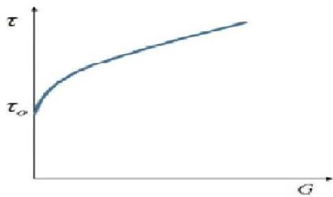
Slika 4. Krivulja protoka ne-Newtonovog fluida [5]
