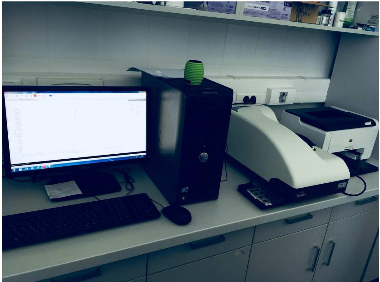
Slika 14. Uređaj Zetasizer nano Z
