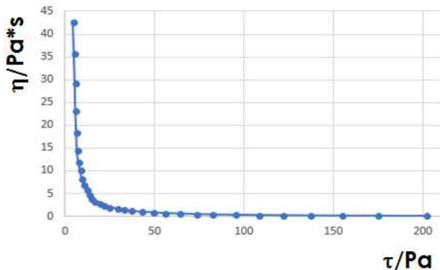
Slika 19. Graf ovisnosti viskoznosti o smičnoj sile
