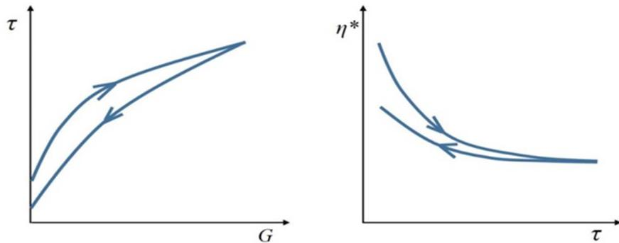
Slika 7. Krivulje protoka i viskoznosti tiksotropnog fluida [5]
