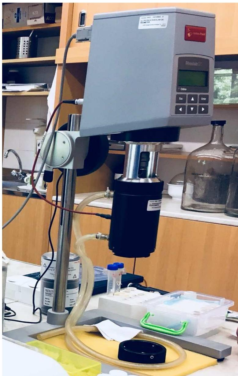
Slika 15. Rotacijski reometar Anton Paar RheolabQC
