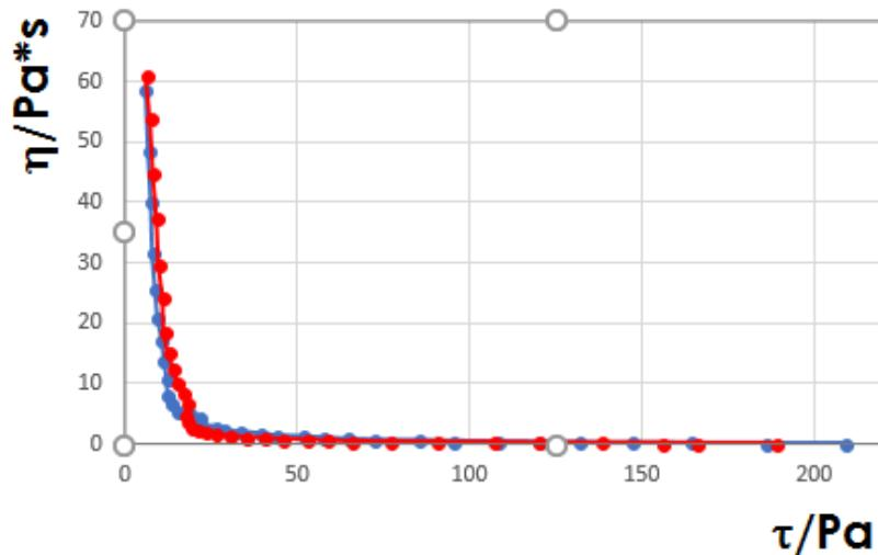
Slika 20. Grafički prikaz dva mjerena u razmaku od 45 min.; plava početno mjerenje, crvena nakon 45 min.
