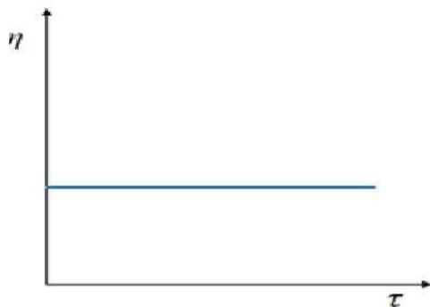
Slika 3. Krivulja viskoznosti Newtonovog fluida [5]
