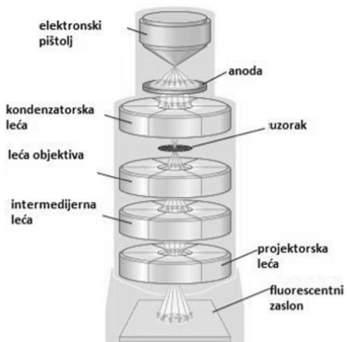
*Slika 20. Shematski prikaz glavnih dijelova TEM-a [62]*
