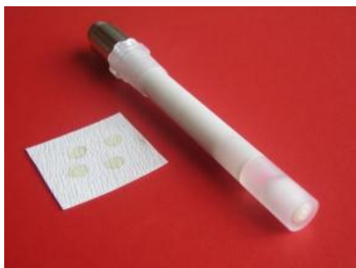
Slika 10: Tenzidno-osjetljiva elektroda s PVC membranom vlastite izradbe [7.]
