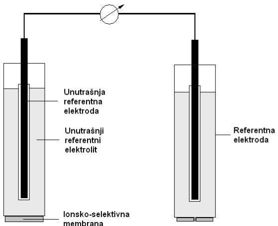
Slika 6: Elektrokemijska mjerna ćelija s ionsko-selektivnom elektrodom
