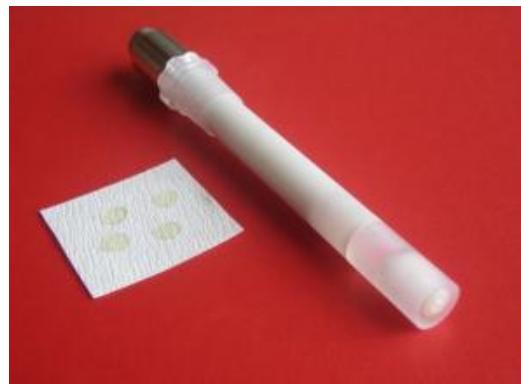
Slika 10: Tenzidno-osjetljiva elektroda s PVC membranom vlastite izradbe [7.]
