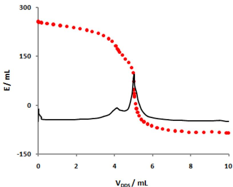
Slika 11: Titracijska krivulja otopine kationskog tenzida oktadecil-trimetil amonijev bromid (OTAB) s anionskim tenzidom DDS ( $4.238 \times 10^{-3}$  mol dm<sup>-3</sup>) i njezina prva derivacija
