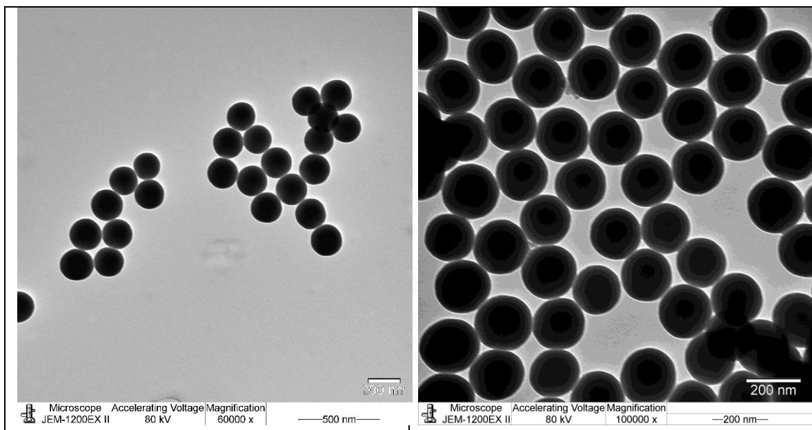
Slika 21. TEM slika silikatnih čestica s 50% modificirane površine APTES-om
