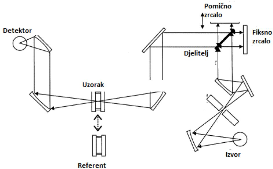
**Slika 6.** Shematski prikaz FT-IR spektrometra s Michelsonovim interferometrom [23]
