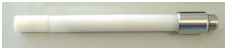
Slika 21. Tijelo Phillips-ove elektrode [30]
