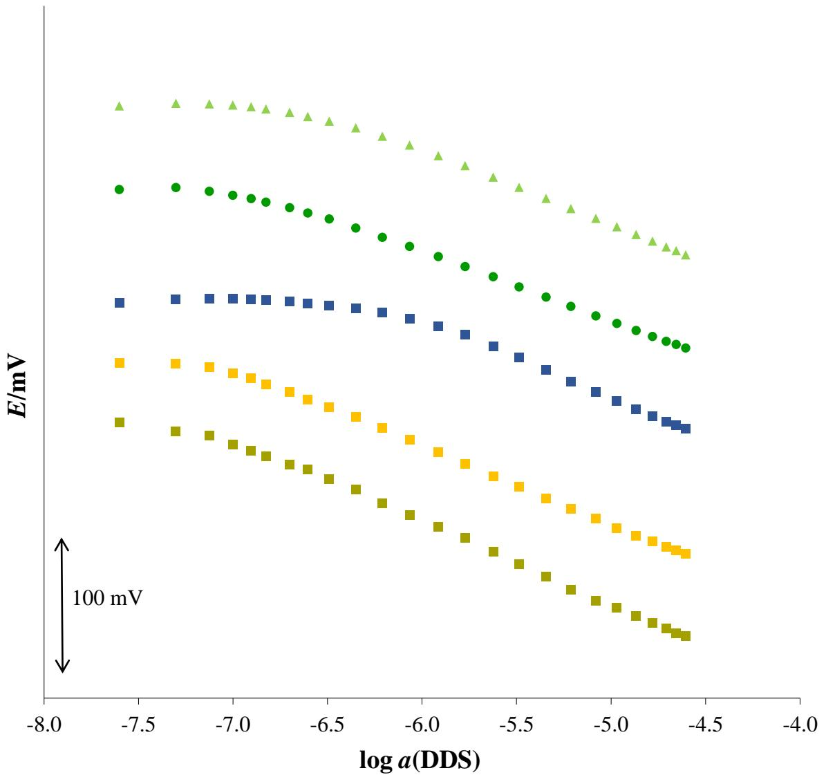
**Slika 16.** Odzivne karakteristike TODA-TPB senzora s različitim elektrolitima na DDS ( $c = 5 \cdot 10^{-5} \text{ M}$ ) u vodi s pauzom (■ 3 M NaCl; ■ 3 M LiCl; ● 3 M  $\text{CH}_3\text{COONa}$ ; ▲ 0.1 M NaDDS; ■ 3 M KCl).
