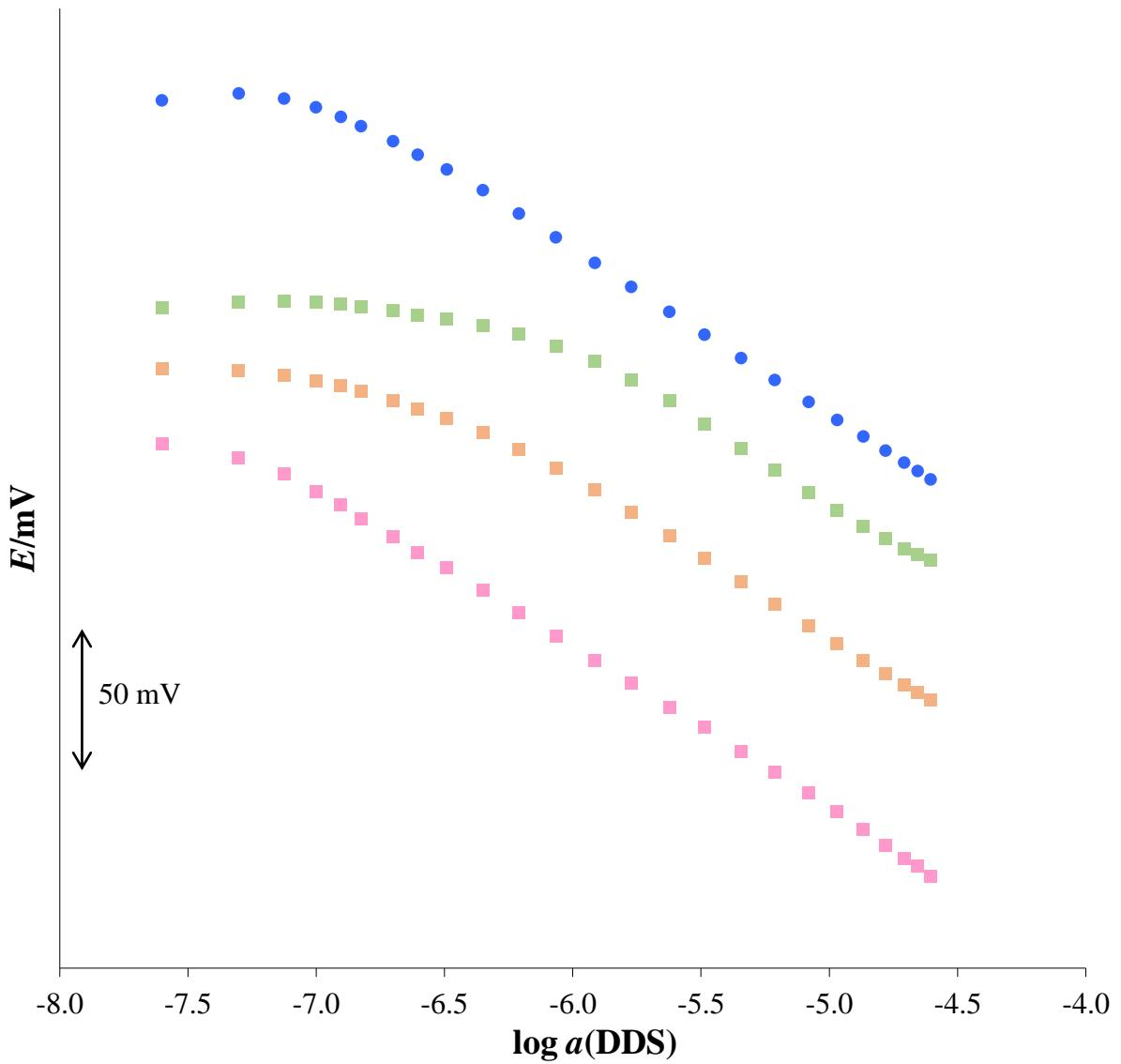
**Slika 17.** Odzivne karakteristike TODA-TPB senzora s različitim elektrolitima na DDS ( $c = 5 \cdot 10^{-5}$  M) u 0.01 M  $\text{Na}_2\text{SO}_4$  (■ 3 M NaCl; □ 3 M LiCl; ● 3 M  $\text{CH}_3\text{COONa}$ ; ▨ 3 M KCl).
