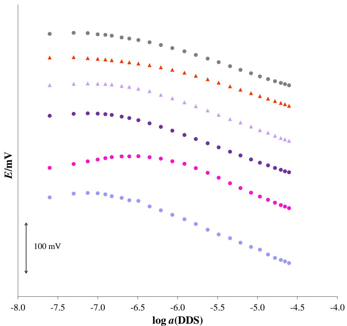
**Slika 18.** Odzivne karakteristike TODA-TPB senzora s različitim elektrolitima na DDS ( $c = 5 \cdot 10^{-5} \text{ M}$ ) u vodi bez pauze (● 0.5 M NaCl; ● 0.5 M LiCl; ● 0.001 M NaDDS; ▲ 0.001 M NaTPB; ▲ 0.5 M  $\text{CH}_3\text{COONa}$ ; ● 0.5 M KCl).
