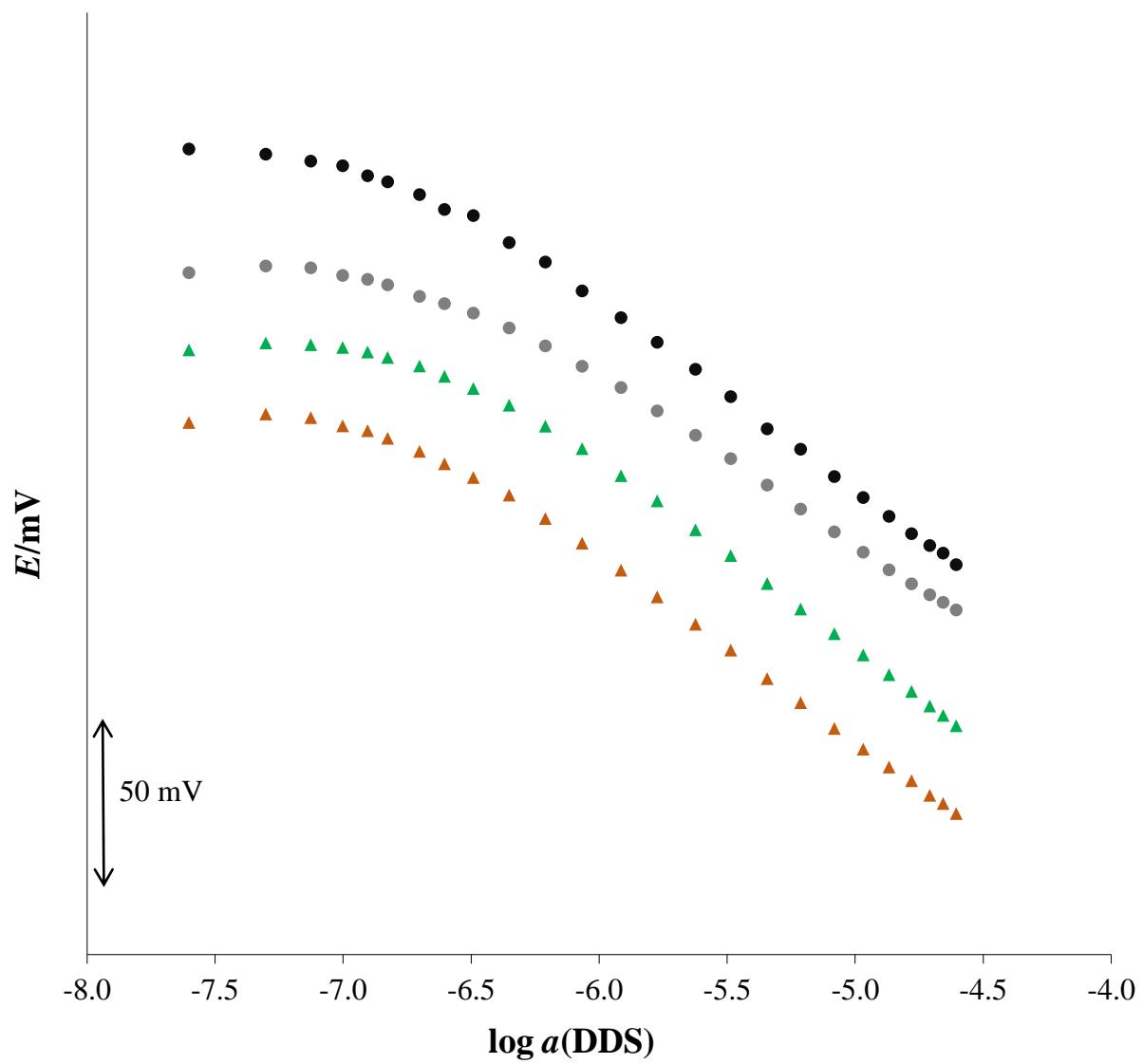
**Slika 25.** Odzivne karakteristike TODA-TPB senzora na DDS ( $c = 5 \cdot 10^{-5}$  M) u vodi (bez pauze i s pauzom) i 0.01 M  $\text{Na}_2\text{SO}_4$  ( $\blacktriangle$  0.1 M NaDDS u vodi bez pauze;  $\blacklozenge$  0.1 M NaDDS u vodi s pauzom;  $\bullet$  0.001 M NaDDS u vodi bez pauze;  $\bullet$  0.001 M NaDDS u vodi s pauzom).
