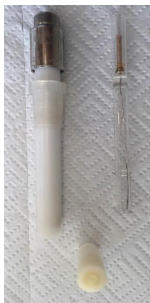
**Slika 12.** Prikaz dijelova tijela Philipsove elektrode.
