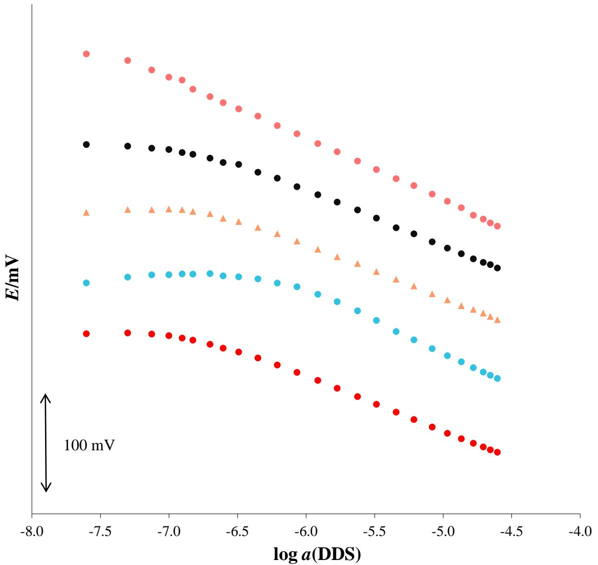
**Slika 19.** Odzivne karakteristike TODA-TPB senzora s različitim elektrolitima na DDS ( $c = 5 \cdot 10^{-5} \text{ M}$ ) u vodi s pauzom (● 0.5 M NaCl; ● 0.001 M NaDDS; ● 0.5 M LiCl; ▲ 0.5 M  $\text{CH}_3\text{COONa}$ ; ● 0.5 M KCl).
