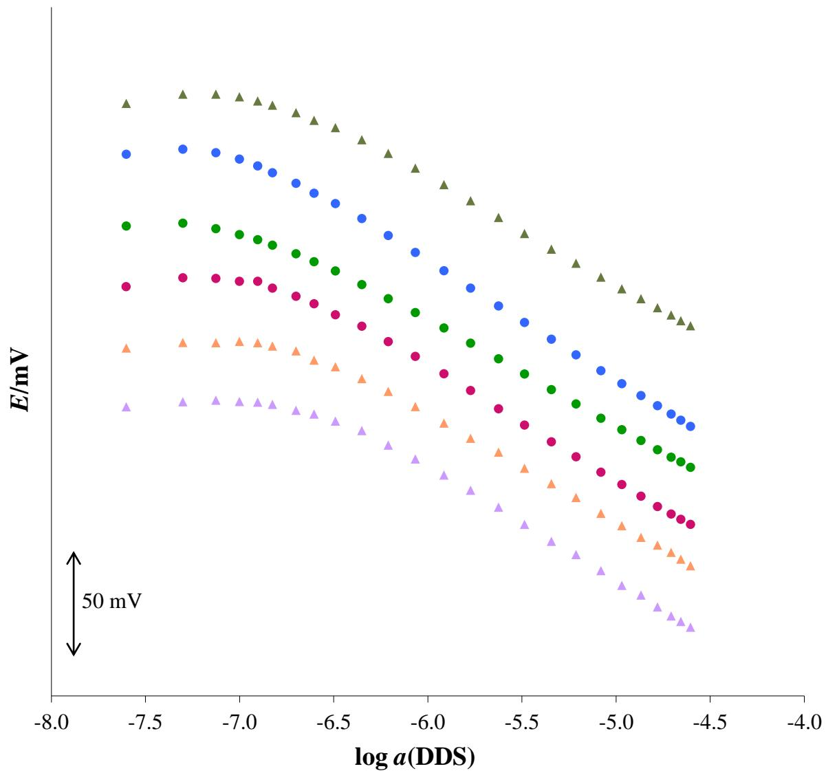
**Slika 24.** Odzivne karakteristike TODA-TPB senzora na DDS ( $c = 5 \cdot 10^{-5}$  M) u vodi (bez pauze i s pauzom) i 0.01 M  $\text{Na}_2\text{SO}_4$  (● 3 M  $\text{CH}_3\text{COONa}$  u vodi bez pauze; ● 3 M  $\text{CH}_3\text{COONa}$  u vodi s pauzom; ● 3 M  $\text{CH}_3\text{COONa}$  u  $\text{Na}_2\text{SO}_4$ ; ▲ 0.5 M  $\text{CH}_3\text{COONa}$  u vodi bez pauze; ▲ 0.5 M  $\text{CH}_3\text{COONa}$  u vodi s pauzom; ▲ 0.5 M  $\text{CH}_3\text{COONa}$  u  $\text{Na}_2\text{SO}_4$ ).
