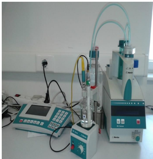
Slika 8. Prikaz instrumenta koji je korišten za ispitivanje odzivnih karakteristika senzora (Dosimat 765).
