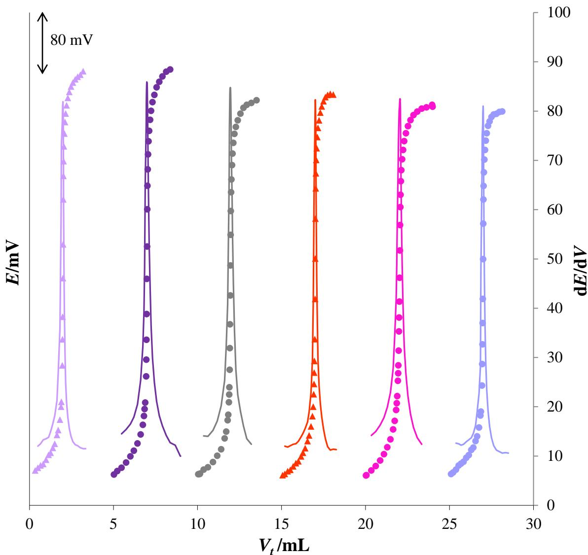
**Slika 14.** Potenciometrijske titracijske krivulje i njihove prve derivacije za NaDDS ( $c = 4 \cdot 10^{-3}$  M) uz CPC ( $c = 4 \cdot 10^{-3}$  M) kao titrant i TODA-TPB senzor kao detektor završne točke titracije s različitim elektrolitima (0.5 M  $\text{CH}_3\text{COONa}$  ▲,—; 0.5 M  $\text{NaCl}$  ●,—; 0.001 M NaDDS ●,—; 0.001 M NaTPB ▲,—; 0.5 M  $\text{LiCl}$  ●,—; 0.5 M  $\text{KCl}$  ●,—).
