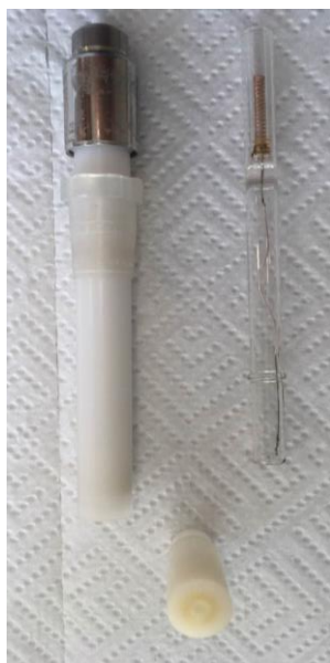
Slika 12. Prikaz dijelova tijela Philipsove elektrode.
