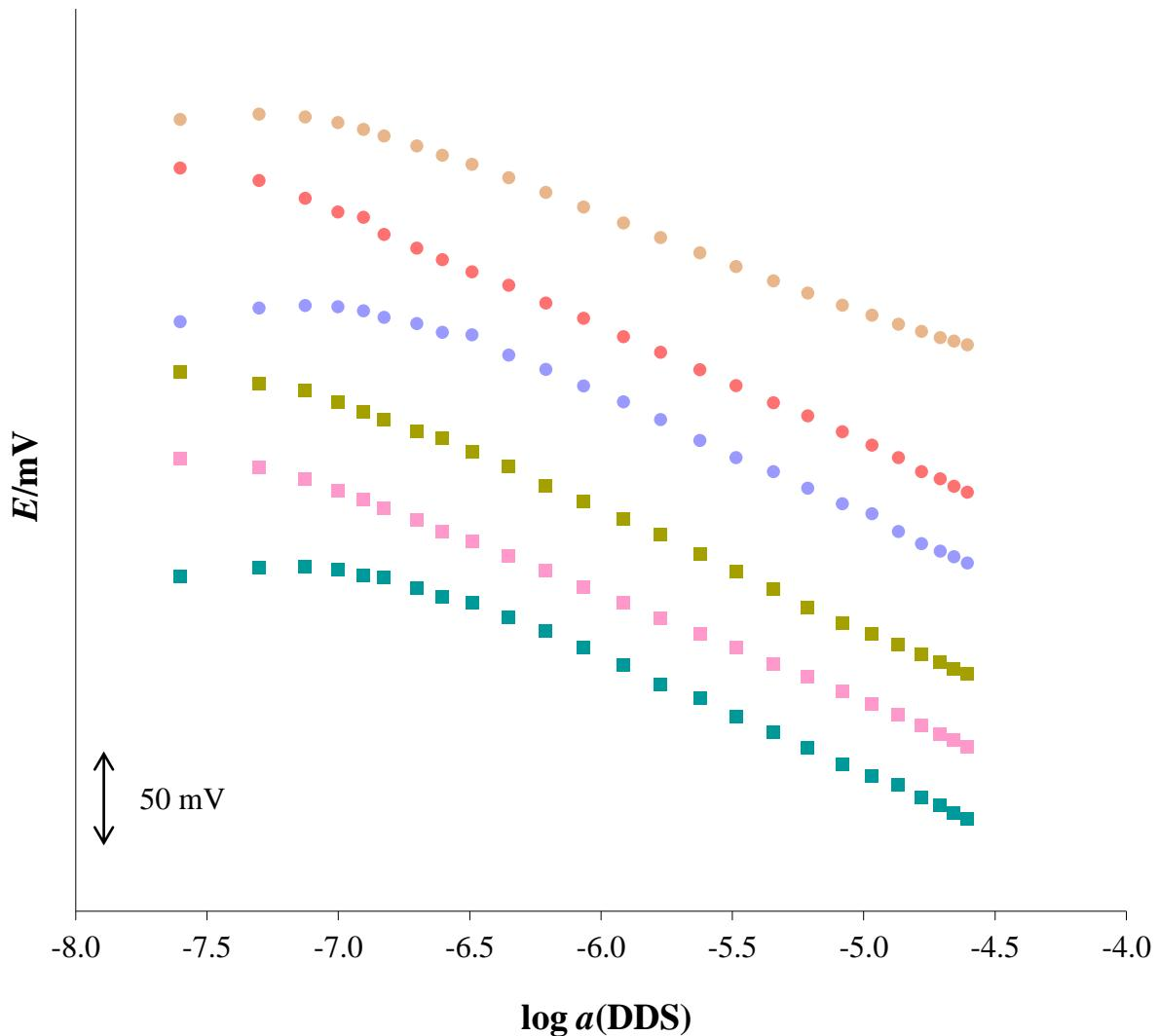
**Slika 22.** Odzivne karakteristike TODA-TPB senzora na DDS ( $c = 5 \cdot 10^{-5}$  M) u vodi (bez pauze i s pauzom) i 0.01 M  $\text{Na}_2\text{SO}_4$  (■ 3 M KCl u vodi bez pauze; ■ 3 M KCl u vodi s pauzom; ▨ 3 M KCl u  $\text{Na}_2\text{SO}_4$ ; ● 0.5 M KCl u vodi bez pauze; ● 0.5 M KCl u vodi s pauzom; ● 0.5 M KCl u  $\text{Na}_2\text{SO}_4$ ).
