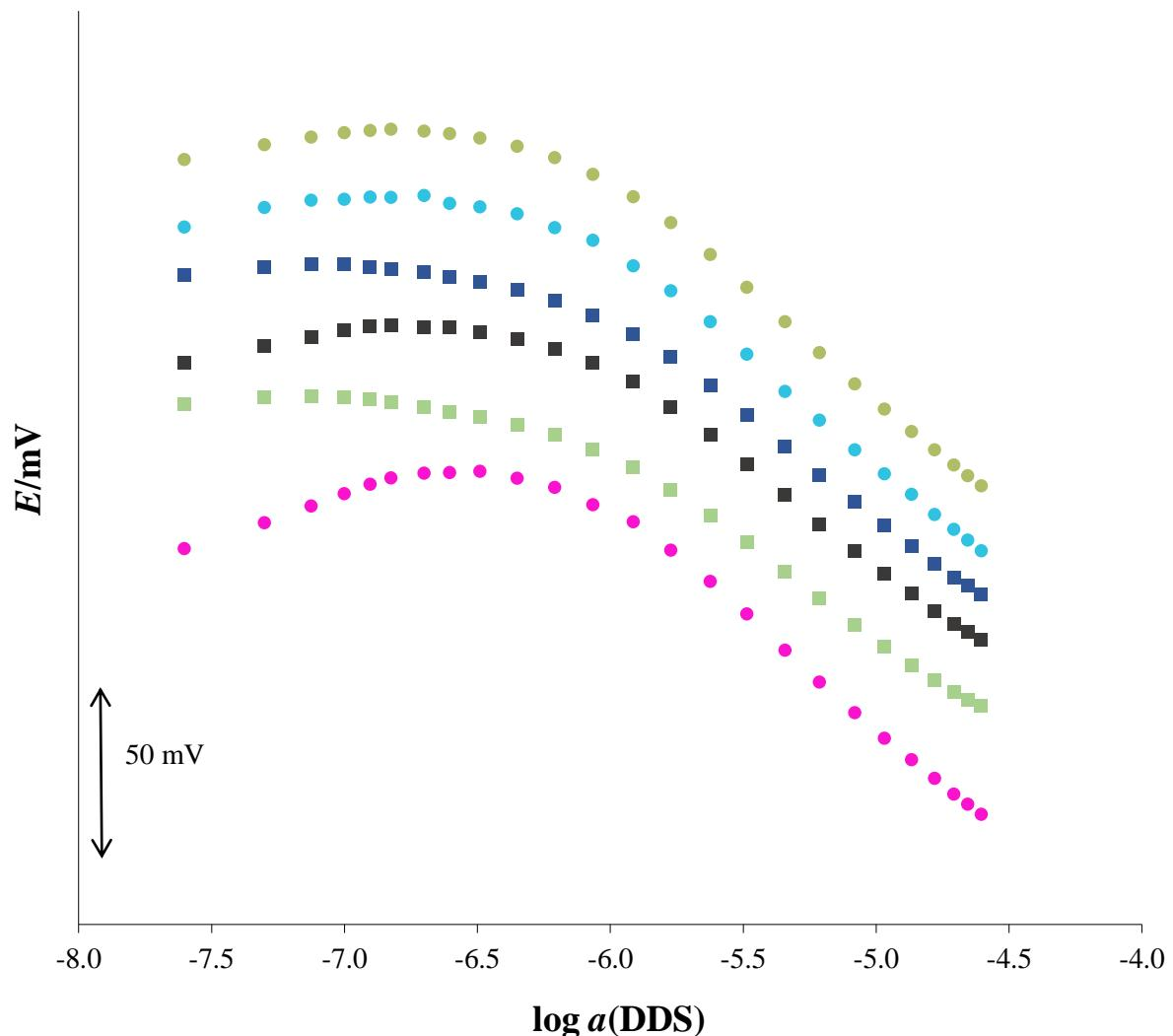
**Slika 23.** Odzivne karakteristike TODA-TPB senzora na DDS ( $c = 5 \cdot 10^{-5}$  M) u vodi (bez pauze i s pauzom) i 0.01 M  $\text{Na}_2\text{SO}_4$  (■ 3 M LiCl u vodi bez pauze; ▨ 3 M LiCl u vodi s pauzom; ▨ 3 M LiCl u  $\text{Na}_2\text{SO}_4$ ; ● 0.5 M LiCl u vodi bez pauze; ○ 0.5 M LiCl u vodi s pauzom; ● 0.5 M LiCl u  $\text{Na}_2\text{SO}_4$ ).
