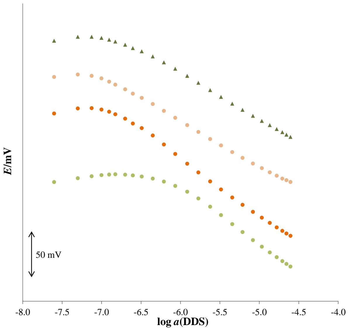
**Slika 20.** Odzivne karakteristike TODA-TPB senzora s različitim elektrolitima na DDS ( $c = 5 \cdot 10^{-5} \text{ M}$ ) u  $0.01 \text{ M } \text{Na}_2\text{SO}_4$  (● 0.5 M  $\text{NaCl}$ ; ● 0.5 M  $\text{LiCl}$ ; ▲ 0.5 M  $\text{CH}_3\text{COONa}$ ; ● 0.5 M  $\text{KCl}$ ).
