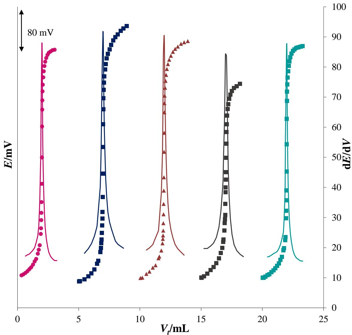
**Slika 13.** Potenciometrijske titracijske krivulje i njihove prve derivacije za NaDDS ( $c = 4 \cdot 10^{-3}$  M) uz CPC ( $c = 4 \cdot 10^{-3}$  M) kao titrant i TODA-TPB senzor kao detektor završne točke titracije s različitim elektrolitima (3 M CH<sub>3</sub>COONa ●,—; 3 M NaCl ■,—; 0.1 M NaDDS ▲,—; 3M LiCl ■,—; 3 M KCl ■,—).
