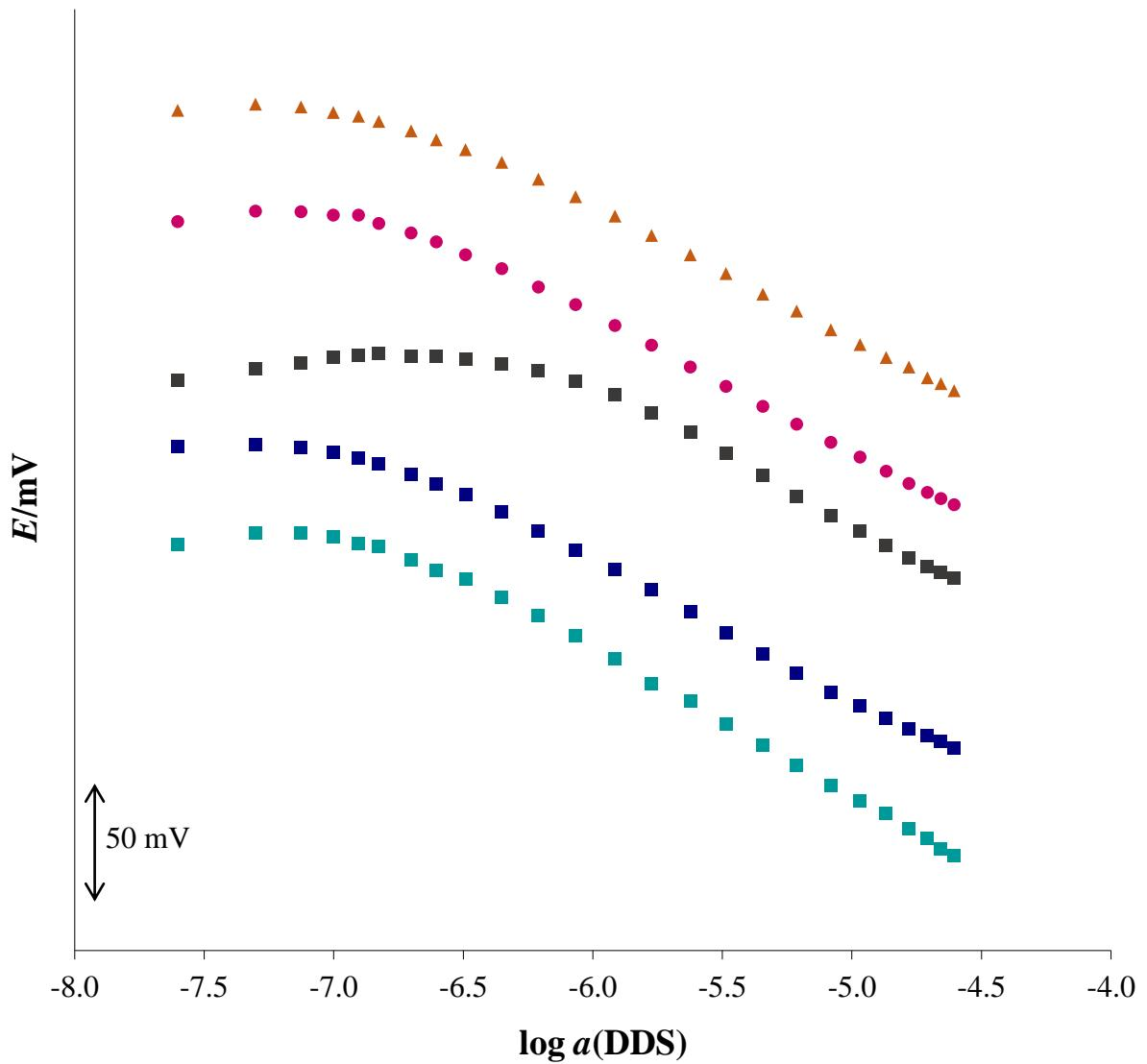
**Slika 15.** Odzivne karakteristike TODA-TPB senzora s različitim elektrolitima na DDS ( $c = 5 \cdot 10^{-5} \text{ M}$ ) u vodi bez pauze (■ 3 M NaCl; ▲ 0.1 M NaDDS; ■ 3 M LiCl; ● 3 M CH<sub>3</sub>COONa; ■ 3 M KCl).
