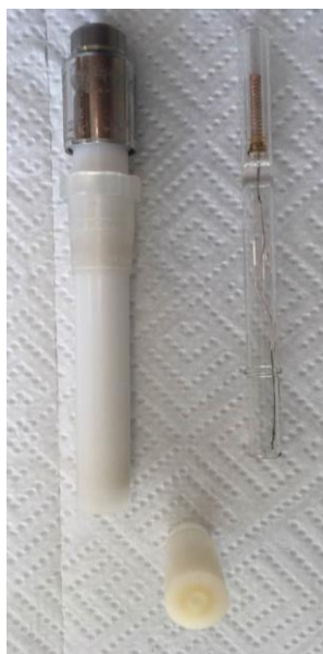
Slika 12. Prikaz dijelova tijela Philipsove elektrode.
