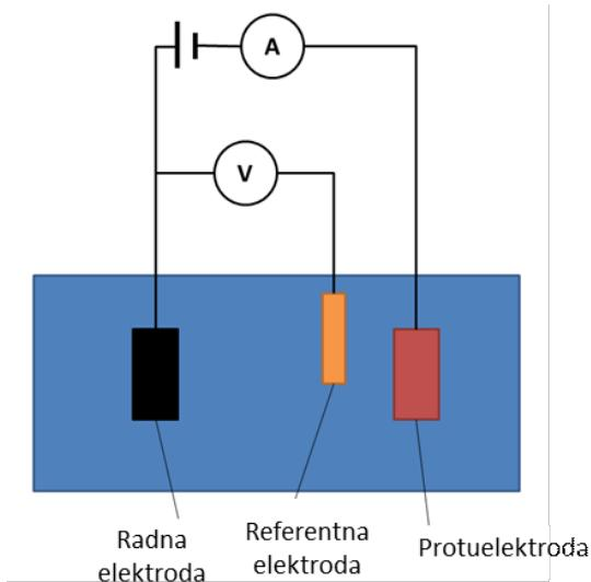
**Slika 3.2.** Prikaz troelektrodnog sustava korištenog za voltametrijska mjerena [5].
