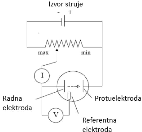
**Slika 3.1.** Shematski prikaz aparature za voltametrijska mjerena [5].
