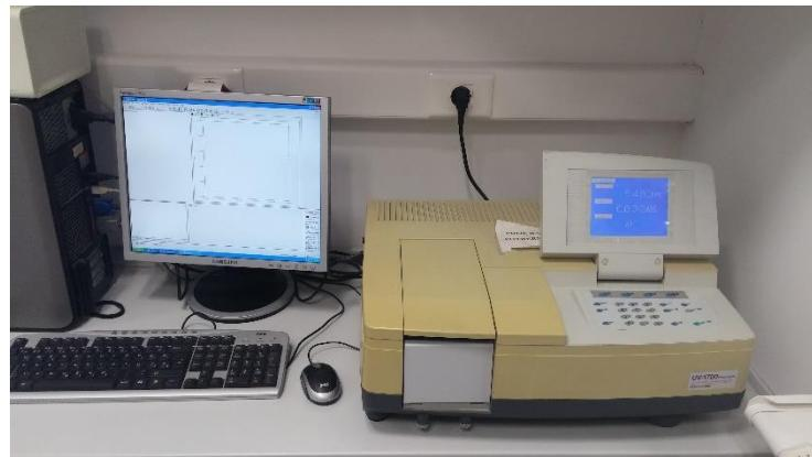
**Slika 3.7.** Aparatura za UV/VIS mjerena, Shimadzu 1700 [6].
