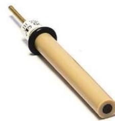
**Slika 3.4.** Radna elektroda od staklastog ugljika (ALS Co., Japan) [6].
