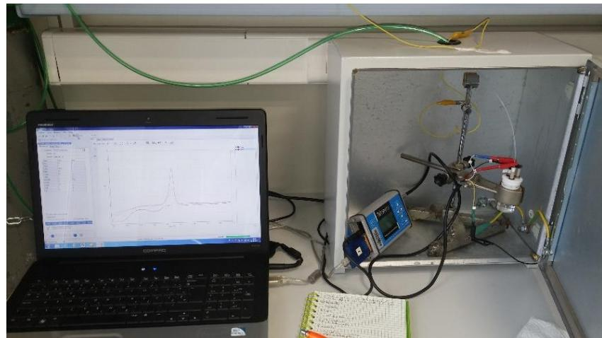
**Slika 3.3.** Aparatura za voltametrijska mjerena koja se sastoji od PalmSens potenciostata/galvanostata, računala s odgovarajućim računalnim programom i boce inertnog plina argona visoke čistoće [6].
