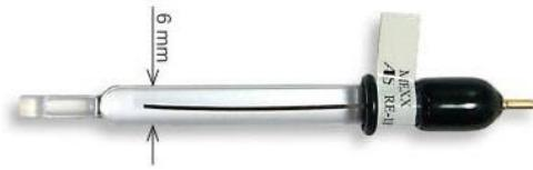
**Slika 3.5.** Referentna srebro/srebrov klorid elektroda ( $\text{Ag}/\text{AgCl}$ ) čiji je unutrašnji elektritolit  $3 \text{ mol dm}^{-3}$  KCl (ALS Co., Japan) [6].
