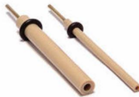
Slika 16. Elektroda od staklastog ugljika [38].
