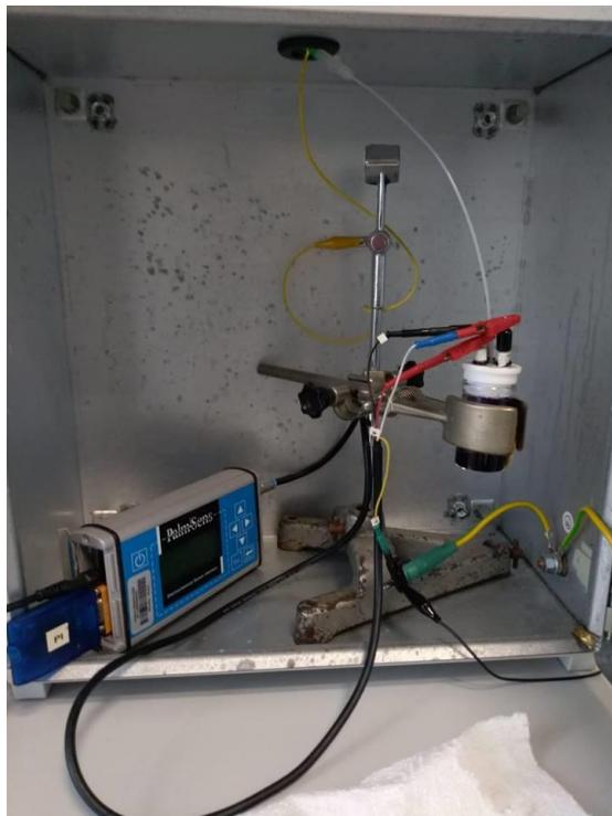
**Slika 15.** Elektrokemijska celija s troelektrodnim sustavom.
