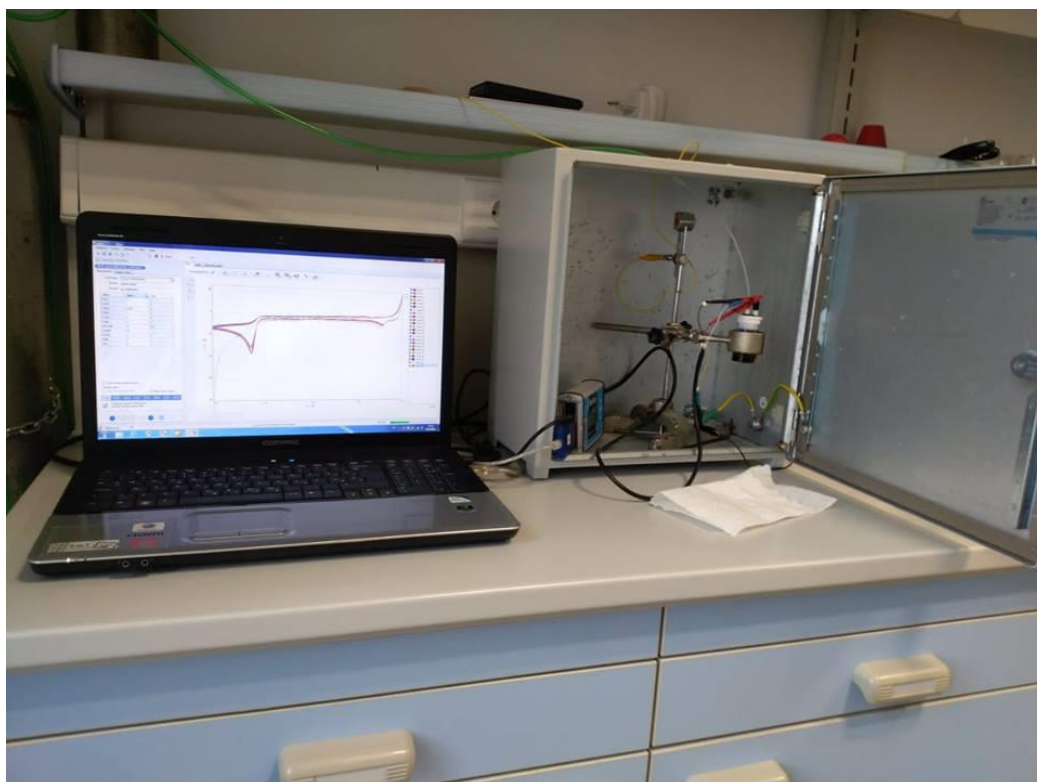
Slika 14. Aparatura za voltometrijska mjerenja, PalmSens potenciostat/galvanostat u Faradayevom kavezu.
