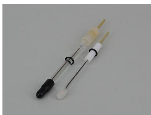
**Slika 18.**  $\text{Ag}/\text{AgCl}$  referentna elektroda [39].
