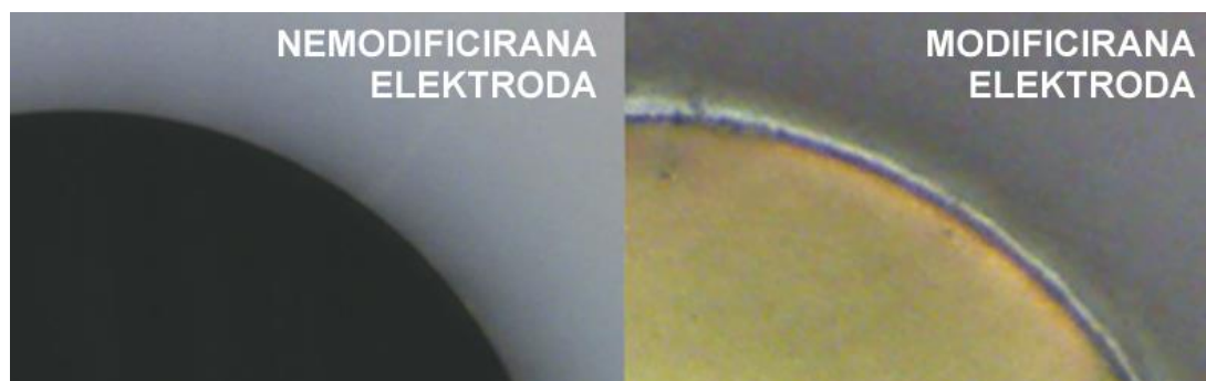
Slika 17. Prikaz površine nemodificirane i modificirane elektrode od staklastog ugljika snimljene na svjetlosnom mikroskopu ELV 79852 (maksimalno uvećanje 500 puta).
