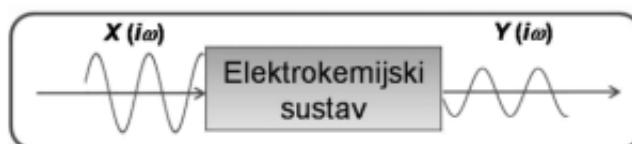
**Slika 10.** Shematski prikaz mjerjenja impedancije [34].
