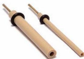
**Slika 16.** Elektroda od staklastog ugljika [38].
