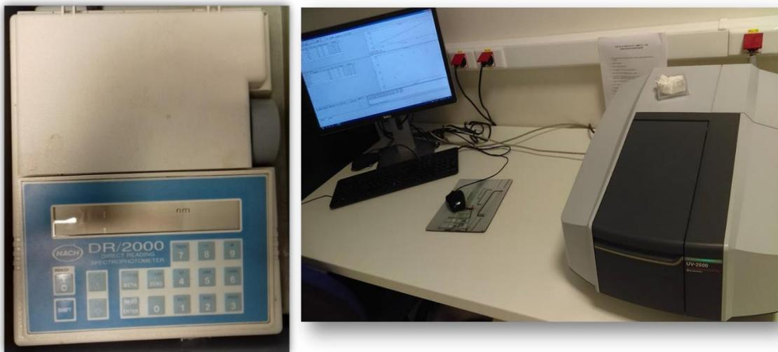
**Slika 15.** Uređaji za spektrofotometrijska mjerena: a) DR/2000 spektrofotometar, Hach i b) UV-2006 spektrofotometar, Mettler Toledo.
