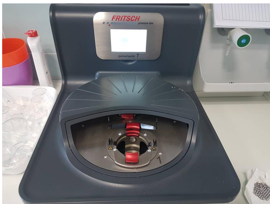
Slika 4. Fritsch Pulverisette 7 Premium model planetarnog kugličnog mlina.
