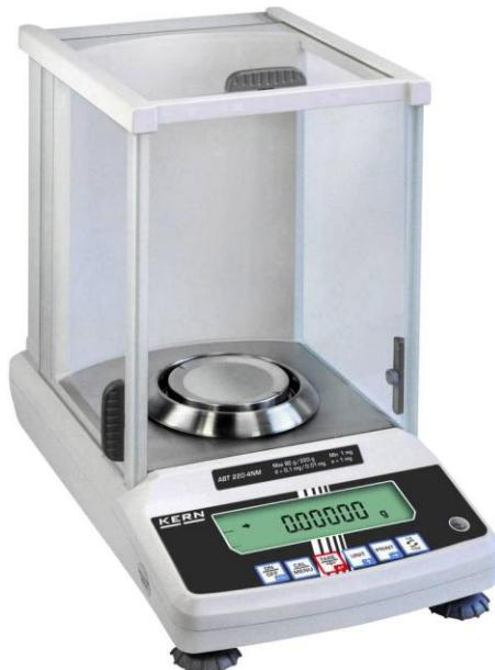
*Slika 8. Digitalna analitička vaga (Kern ALS 220-4NM) [22]*
