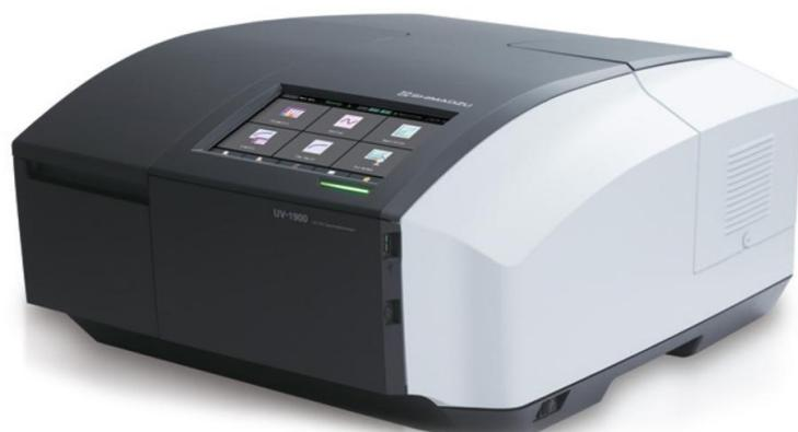
*Slika 9. Spektrofotometar (Shimadzu UV 1900) [23]*
