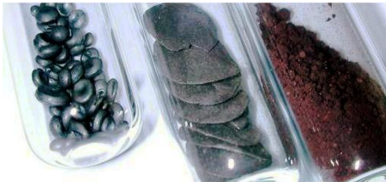
Slika 1. Tri alotropske modifikacije selenija; crni, sivi i crveni selenij [2]
