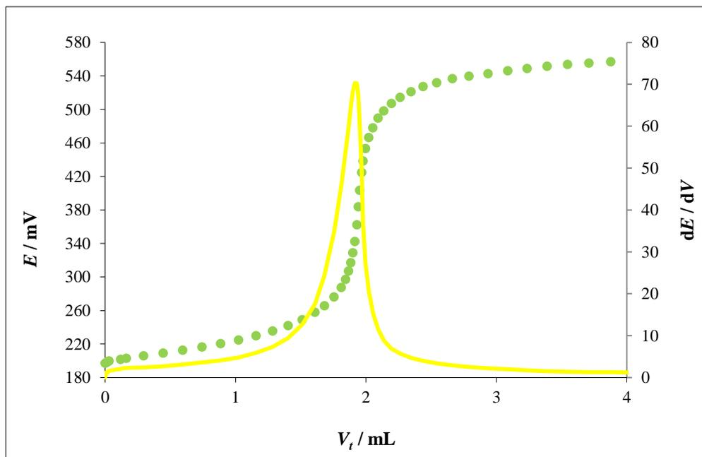
**Slika 20.** Potenciometrijska titracijska krivulja (●) i njena prva derivacija (—) za NaDDS ( $c = 4 \cdot 10^{-3}$  mol/L) uz CPC ( $c = 4 \cdot 10^{-3}$  mol/L) kao titrant i DDA-TPB\_B senzor kao detektor završne točke titracije.
