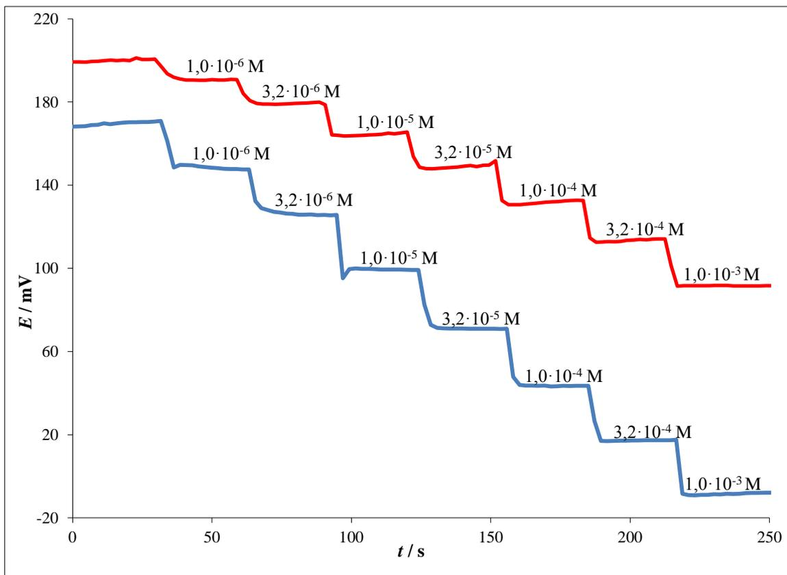
**Slika 27.** Dinamički odziv DDA-TPB\_A (—) i DDA-TPB\_B (—) senzora na NaDDS u H<sub>2</sub>O.
