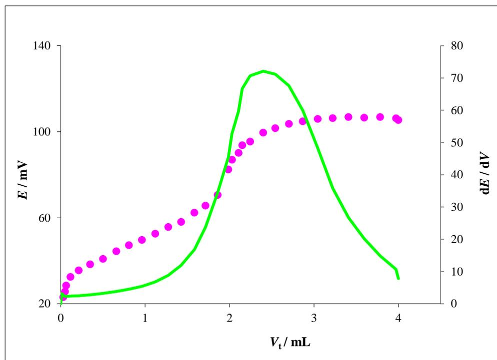
**Slika 21.** Potenciometrijska titracijska krivulja (●) i njena prva derivacija (—) za NaDDS ( $c = 4 \cdot 10^{-3}$  mol/L) uz CPC ( $c = 4 \cdot 10^{-3}$  mol/L) kao titrant i DDA-TPB\_C senzor kao detektor završne točke titracije.
