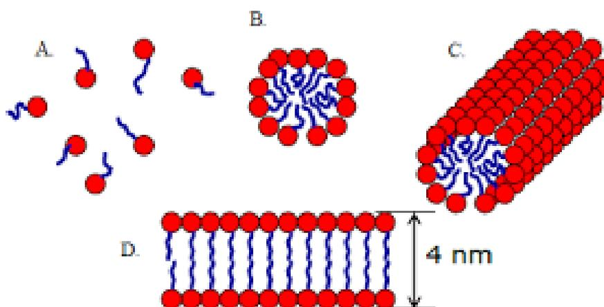
*Slika 4.* Različiti micelarni oblici molekula tenzida u vodenim otopinama. A – monomeri; B – micela sfernog oblika; C – cilindrična micela; D – lamelarna micela [2].
