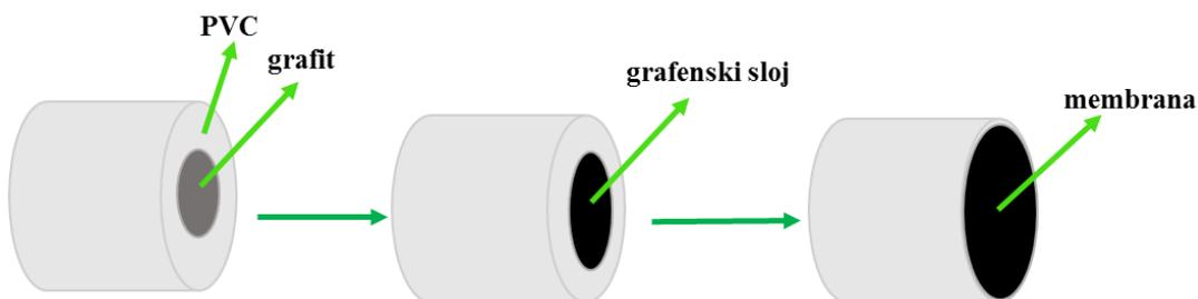
**Slika 16.** Shema indikatorske elektrode.
