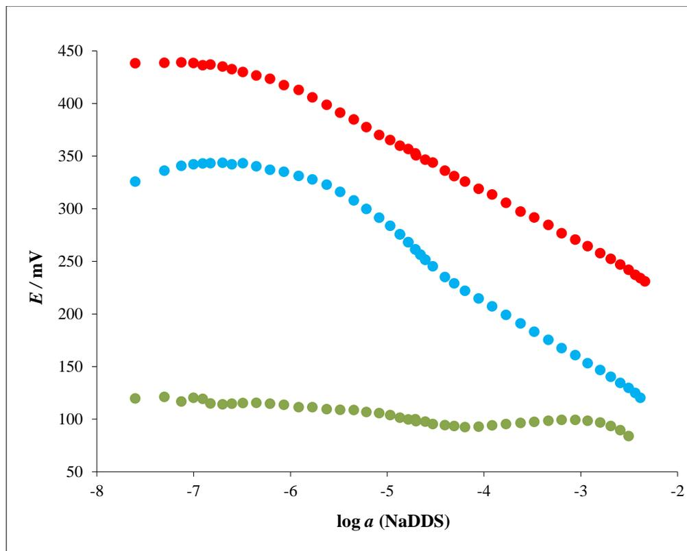
**Slika 26.** Usporedba odzivnih karakteristika DDA-TPB\_A (●), DDA-TPB\_B (●) i DDA-TPB\_C (●) potenciometrijskih senzora na NaDDS u H<sub>2</sub>O.
