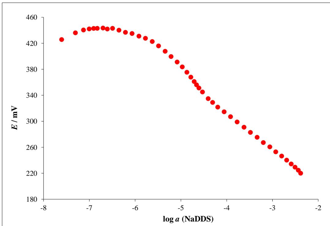
**Slika 24.** Odzivne karakteristike DDA-TPB\_B senzora na NaDDS u H<sub>2</sub>O.
