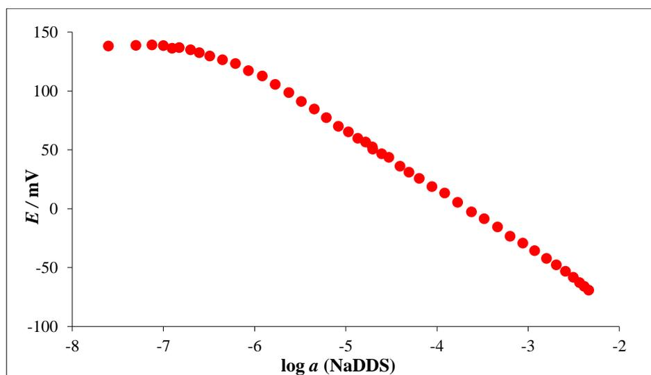
*Slika 23.* Odzivne karakteristike DDA-TPB\_A senzora na NaDDS u H<sub>2</sub>O.
