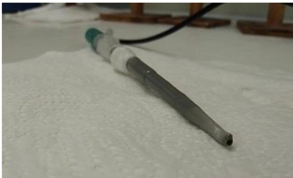
*Slika 14.* Tijelo DDA-TPB\_B elektrode.
