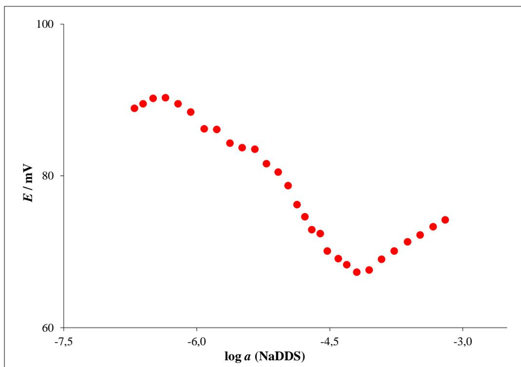
**Slika 25.** Odzivne karakteristike DDA-TPB\_C elektrode na NaDDS u H<sub>2</sub>O.
