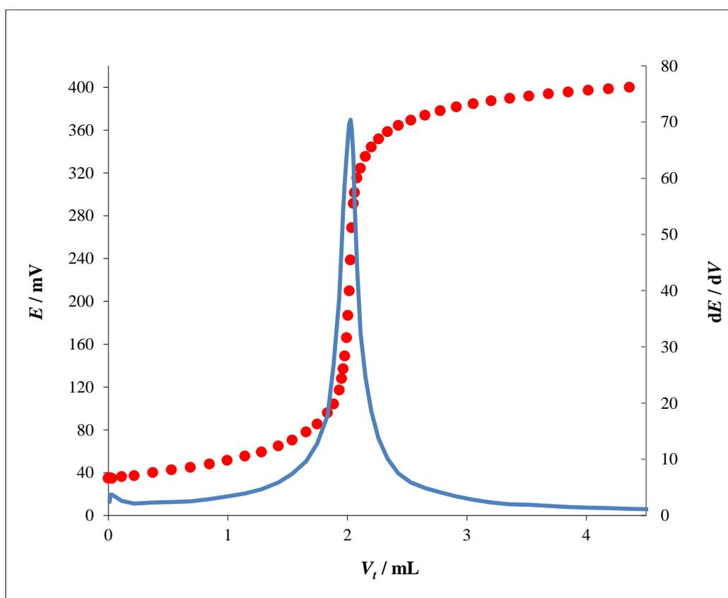
**Slika 19.** Potenciometrijska titracijska krivulja (●) i njena prva derivacija (—) za NaDDS ( $c = 4 \cdot 10^{-3}$  mol/L) uz CPC ( $c = 4 \cdot 10^{-3}$  mol/L) kao titrant i DDA-TPB\_A senzor kao detektor završne točke titracije.
