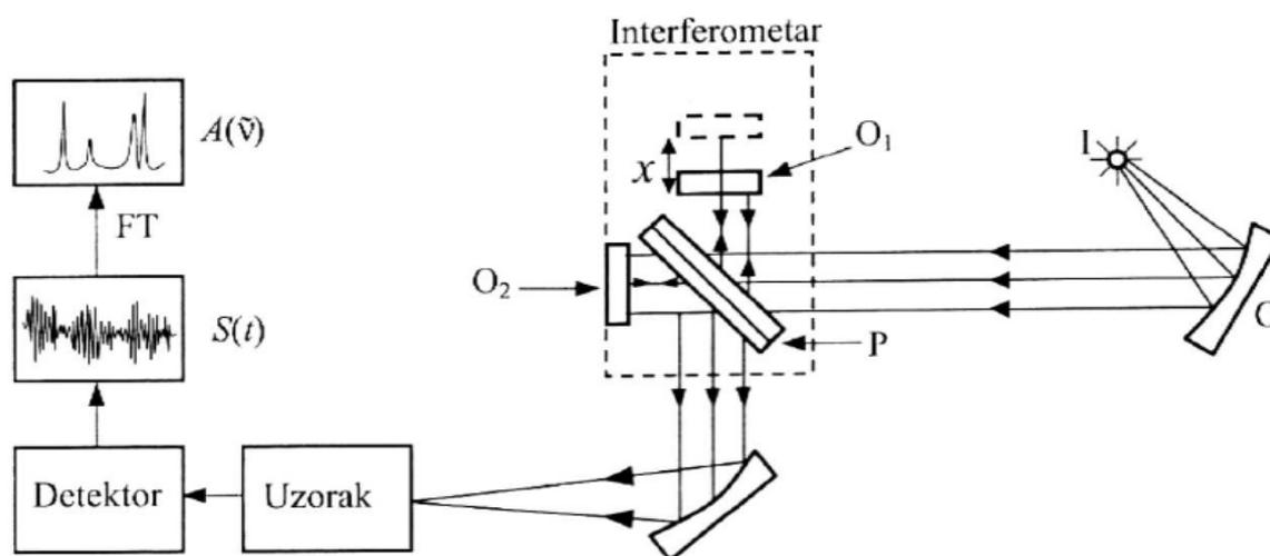
**Slika 18.** Shematski prikaz FTIR spektrofotometra. [22]
