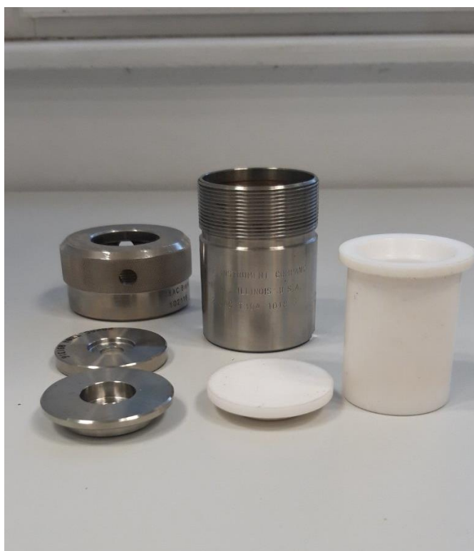
Slika 6. Autoklav korišten za solvotermalnu kemijsku sintezu
