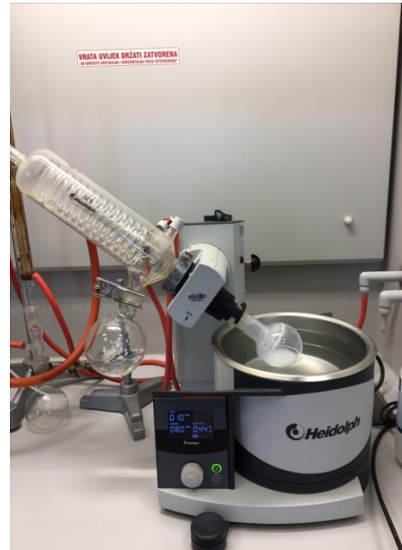
Slika 21. Uparavanje smjese nakon dodatka NaTPB
