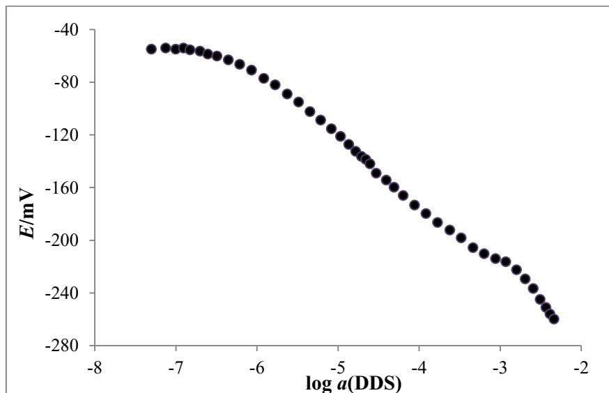
*Slika 34.* Odzivne karakteristike MJ28-TPB senzora na NaDDS u vodi
