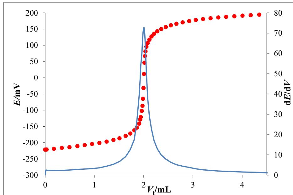
Slika 31. Potenciometrijska titracijska krivulja (●) i njena prva derivacija (—) za NaDDS ( $c = 4 \cdot 10^{-3}$  moldm<sup>-3</sup>) uz CPC ( $c = 4 \cdot 10^{-3}$  moldm<sup>-3</sup>) kao titrans i MJ22-TPB senzor kao detektor završne točke titracije
