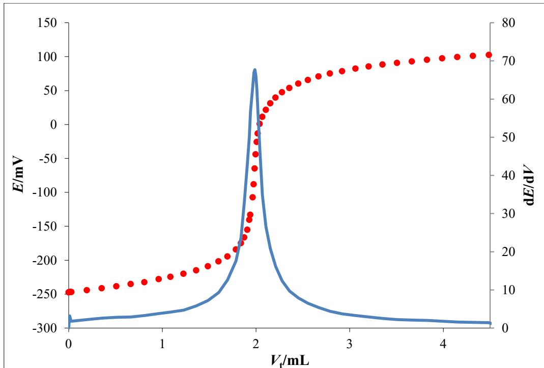
Slika 27. Potenciometrijska titracijska krivulja (●) i njena prva derivacija (—) za NaDDS ( $c = 4 \cdot 10^{-3}$  moldm $^{-3}$ ) uz CPC ( $c = 4 \cdot 10^{-3}$  moldm $^{-3}$ ) kao titrans i MJ1-TPB senzor kao detektor završne točke titracije
