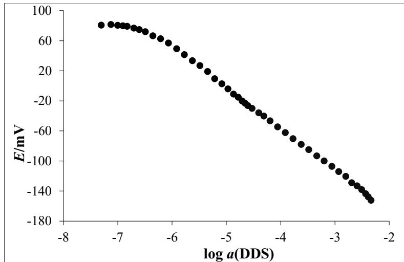
*Slika 30.* Odzivne karakteristike MJ8-TPB senzora na NaDDS u vodi
