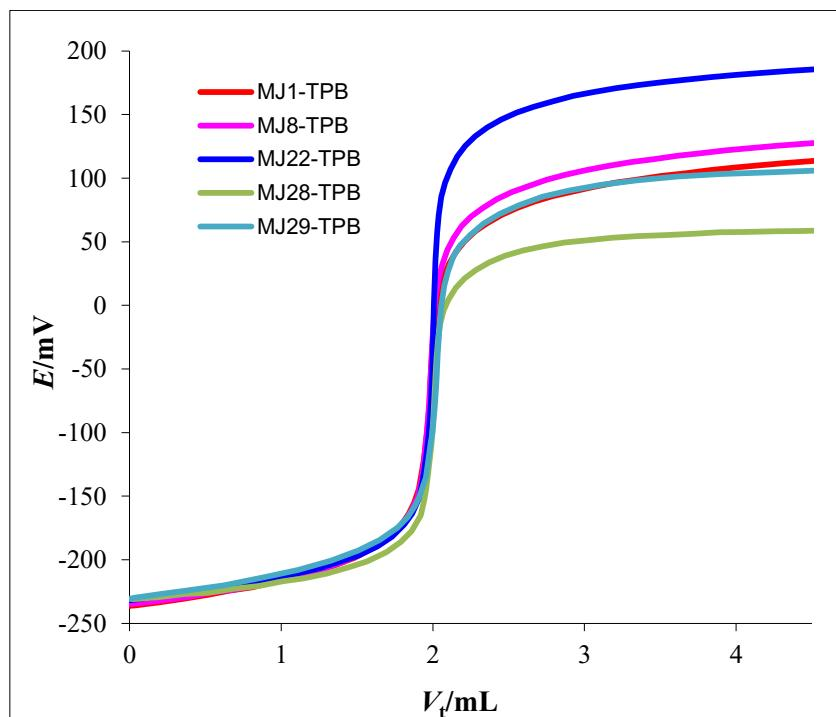
Slika 37. Prikaz titracijskih krivulja za NaDDS ( $c = 4 \cdot 10^{-3} \text{ moldm}^{-3}$ ) uz CPC ( $c = 4 \cdot 10^{-3} \text{ moldm}^{-3}$ ) kao titrans i različite senzore kao detektore završne točke
