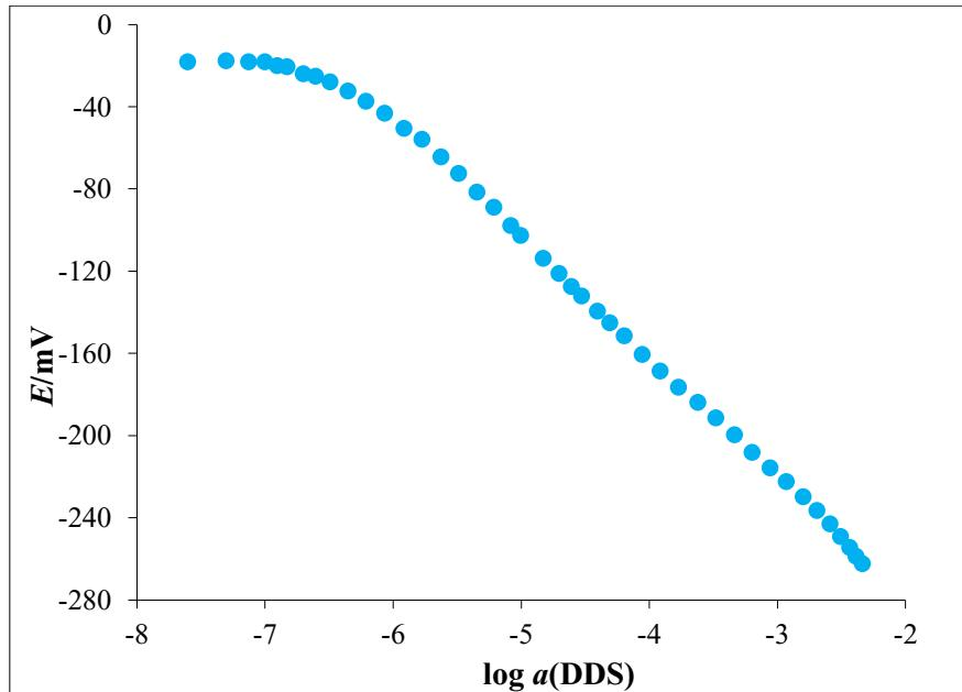
*Slika 28.* Odzivne karakteristike MJ1-TPB senzora na NaDDS u vodi
