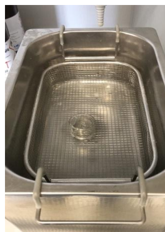
Slika 23. Otopanje smjese na ultrazvučnoj kupelji
