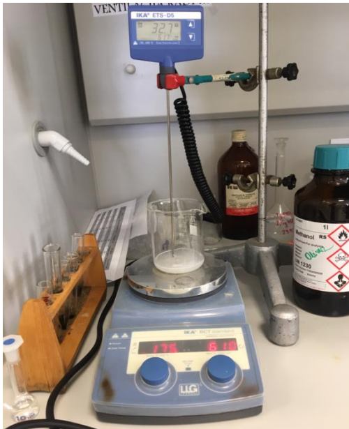
Slika 20. Otapanje kvaterne amonijeve soli uz zagrijavanje i dodatak etanola
