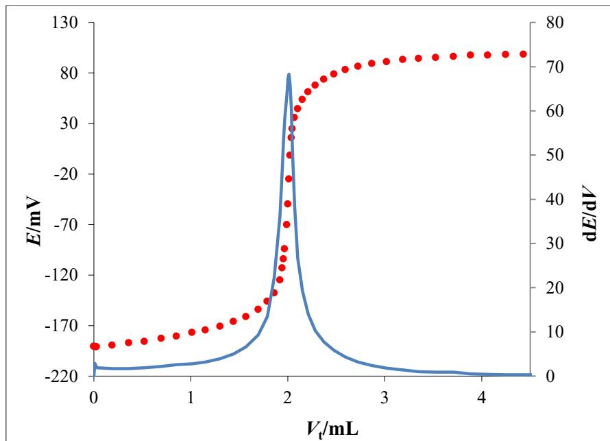
Slika 33. Potenciometrijska titracijska krivulja (●) i njena prva derivacija (—) za NaDDS ( $c = 4 \cdot 10^{-3}$  moldm<sup>-3</sup>) uz CPC ( $c = 4 \cdot 10^{-3}$  moldm<sup>-3</sup>) kao titrans i MJ28-TPB senzor kao detektor završne točke titracije
