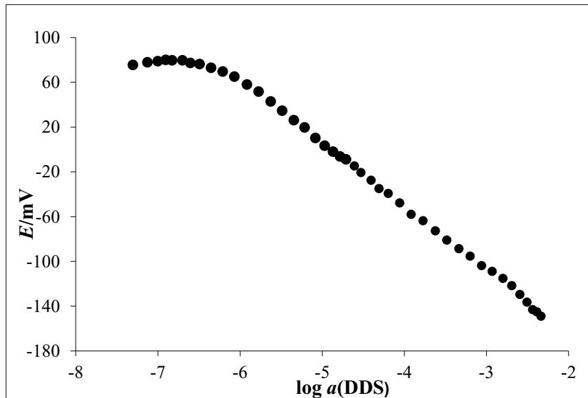
*Slika 36.* Odzivne karakteristike MJ29-TPB senzora na NaDDS u vodi
