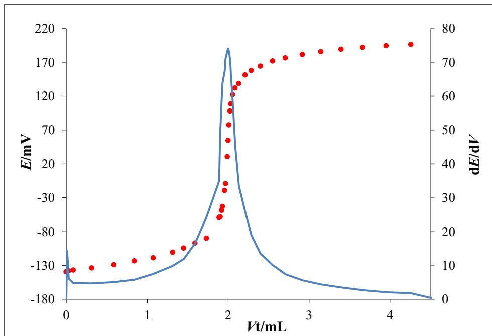
Slika 35. Potenciometrijska titracijska krivulja (●) i njena prva derivacija (—) za NaDDS ( $c = 4 \cdot 10^{-3}$  moldm<sup>-3</sup>) uz CPC ( $c = 4 \cdot 10^{-3}$  moldm<sup>-3</sup>) kao titrans i MJ29-TPB senzor kao detektor završne točke titracije
