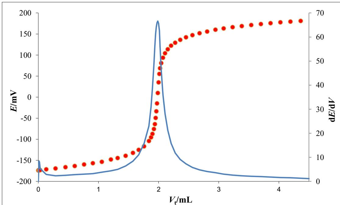
Slika 29. Potenciometrijska titracijska krivulja (●) i njena prva derivacija (—) za NaDDS ( $c = 4 \cdot 10^{-3}$  moldm<sup>-3</sup>) uz CPC ( $c = 4 \cdot 10^{-3}$  moldm<sup>-3</sup>) kao titrans i MJ8-TPB senzor kao detektor završne točke titracije
