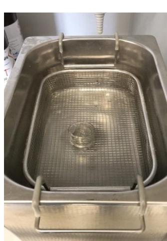
Slika 23. Otapanje smjese na ultrazvučnoj kupelji
