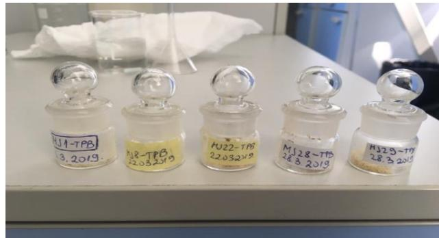
Slika 24. Dobiveni senzorski materijali MJ1-TPB, MJ8-TPB, MJ22-TPB, MJ28-TPB te
