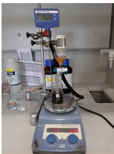
Slika 12. Prikaz koprecipitacijske metode sinteze nanočestica kobalt ferita.
