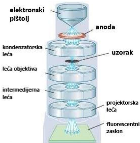
Slika 7. Shematski prikaz komponenata TEM-a [61].
