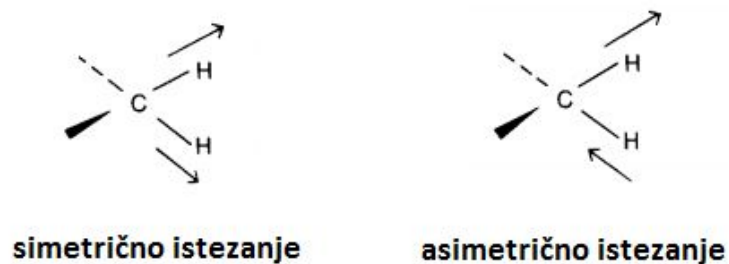
Slika 14. Vibracije istežanja: simetrične i asimetrične [29].
