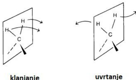
**Slika 15.** Vibracije savijanja: ljuljanje, sjeckanje, klanjanje, uvrтане [29].
