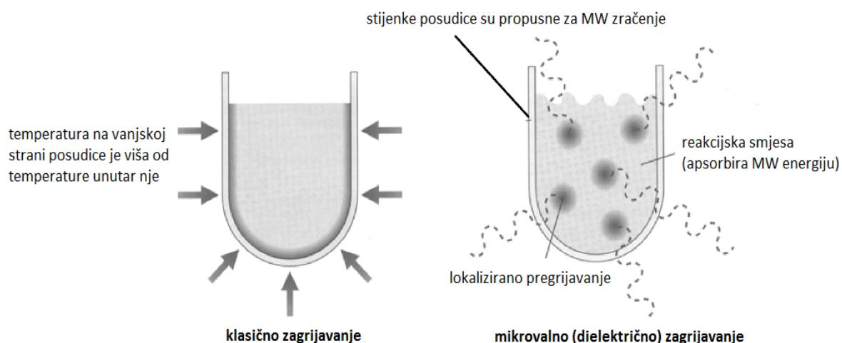
*Slika 7.* Usporedba klasične i mikrovalne sinteze [14].
