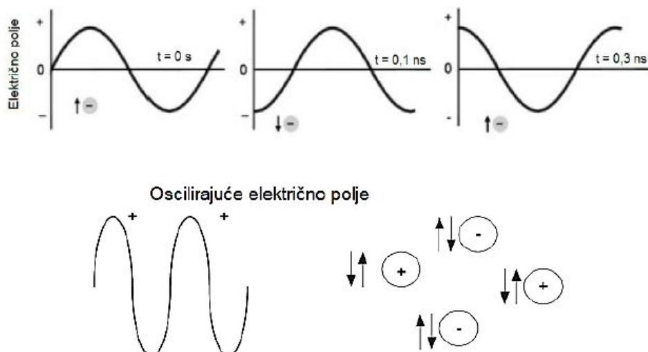
**Slika 6.** Mehanizam ionske vodljivosti [16].
