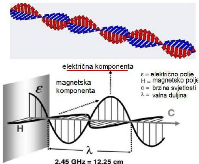
**Slika 4.** Magnetska i električna komponenta mikrovalnog zračenja [16].
