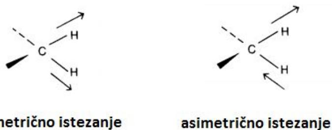
**Slika 14.** Vibracije istezanja: simetrične i asimetrične [29].
