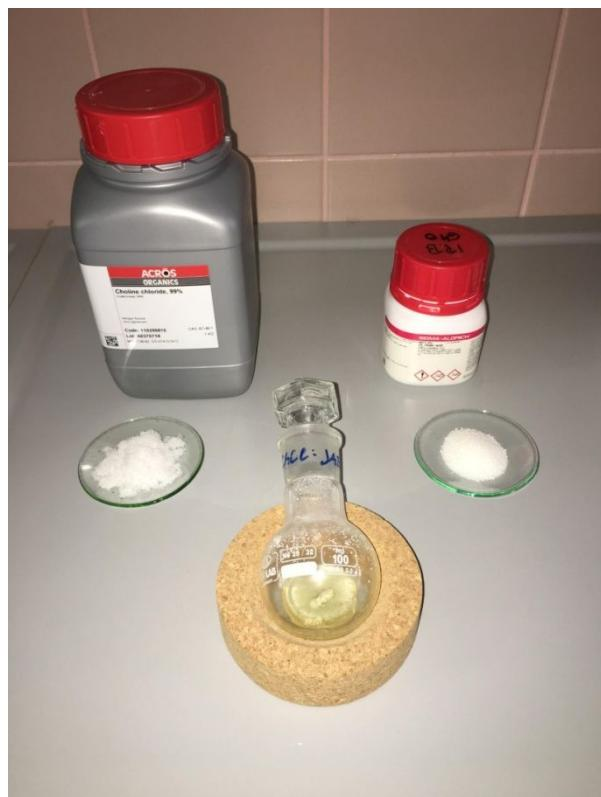
**Slika 17.** Izgled eutektičkog otapala nakon priprave: ChCl (lijevo), JabK (desno), pripremljeno eutektičko otapalo ChCl:JabK (sredina).
