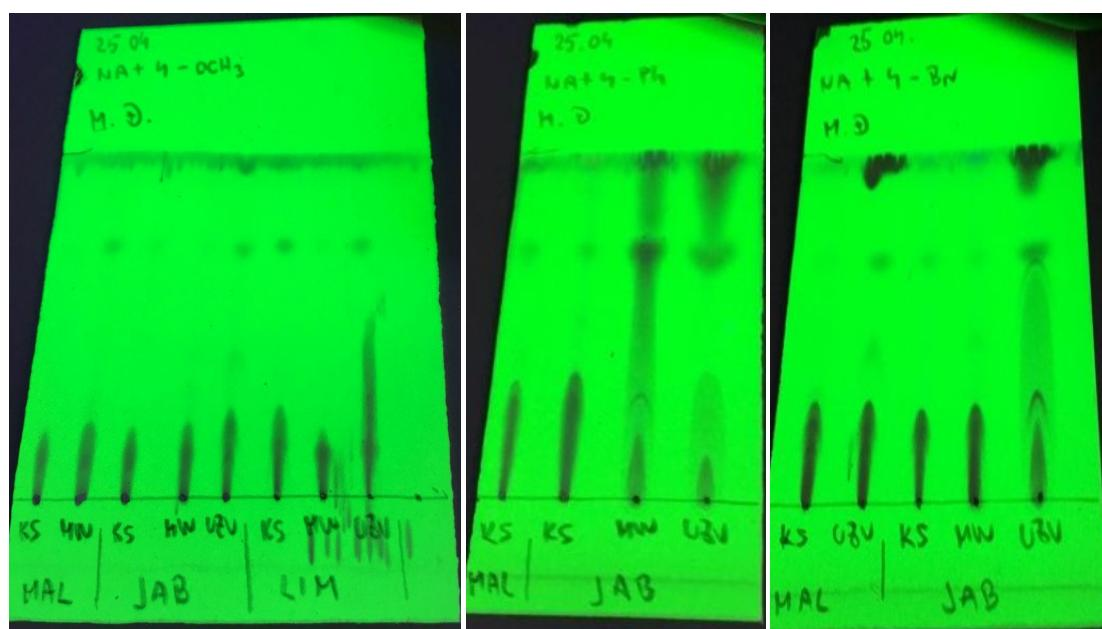
**Slika 22.** TLC izoliranih sirovih produkata: 1 (lijevo), 2 (sredina), 3 (desno).
