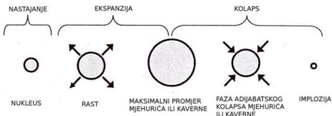
*Slika 8.* Mehanizam kavitacije [19].
