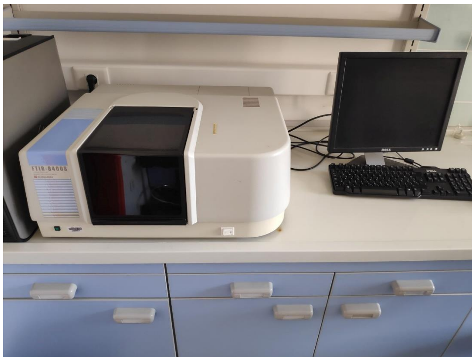
Slika 11. Shimadzu FT-IR 8400S spektrometar.
