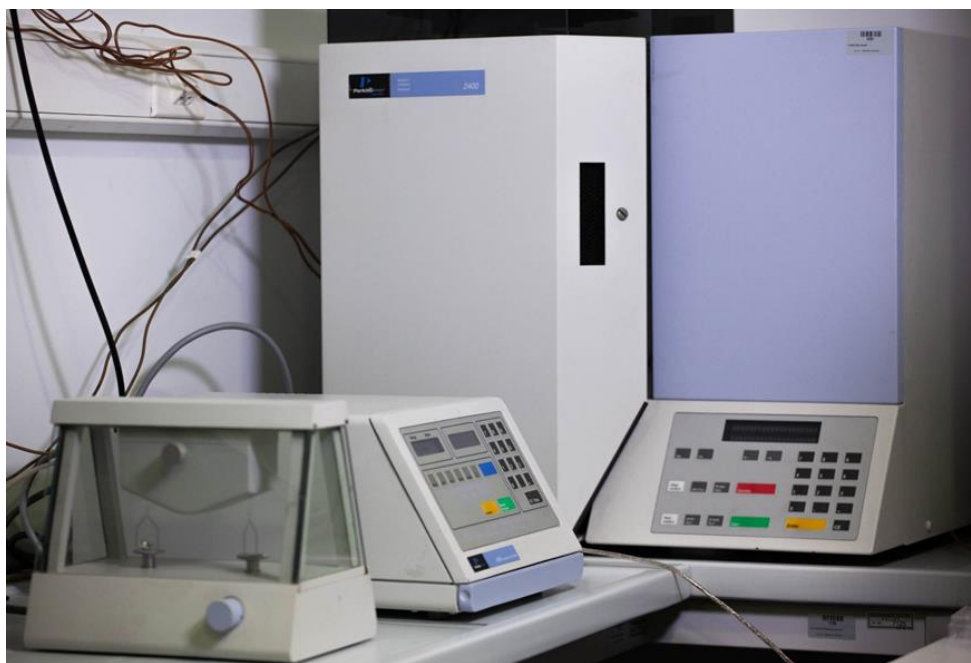
Slika 9. Perkin Elmer, CHNS/O analizator 2400.
