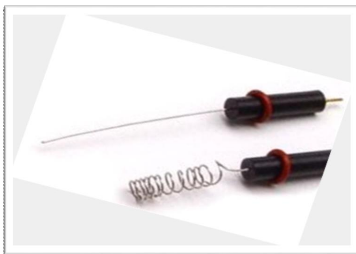
Slika 19. Protuelektroda platinska žica [32].
