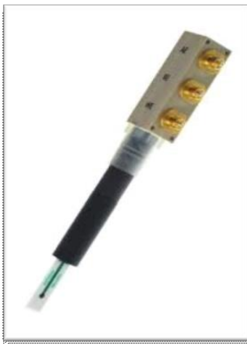
Slika 14. Elektroda za anodnu “stripping“ voltametriju.
