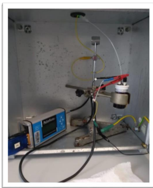
Slika 16. Elektrokemijska ćelija s troelektrodnim sustavom.
