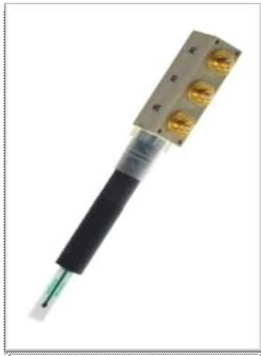
**Slika 14.** Elektroda za anodnu “stripping“ voltametriju.
