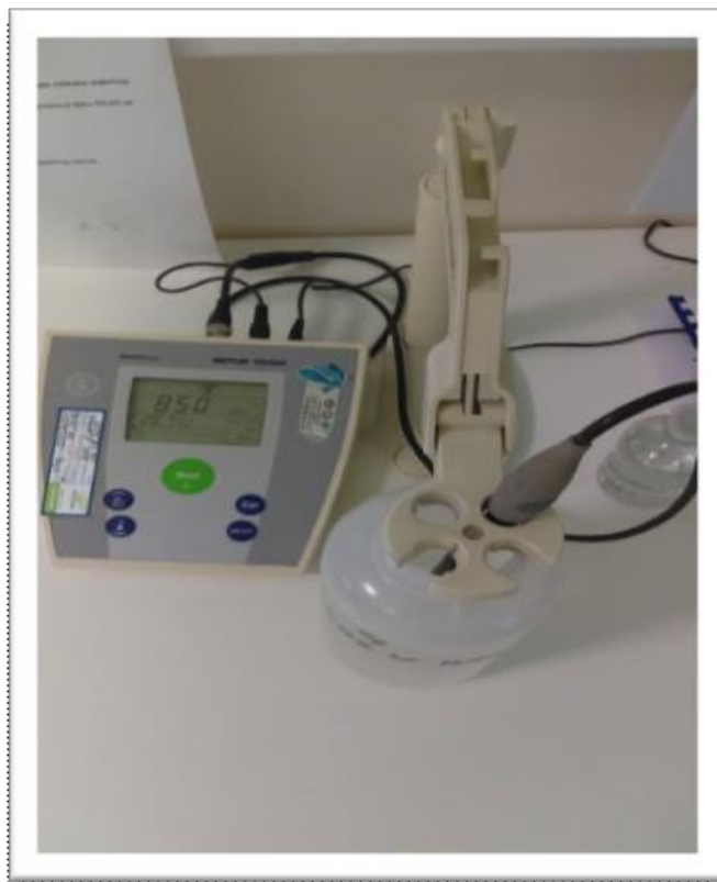
Slika 9. pH metar, Mettler Toledo.
