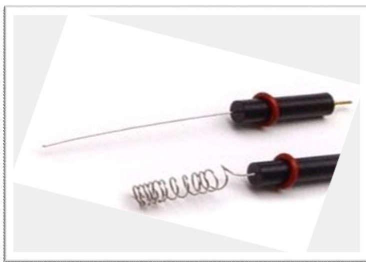
Slika 19. Protuelektroda platinska žica [32].
