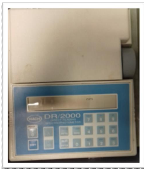
Slika 11. HACH DR 2000 Spektrofotometar.
