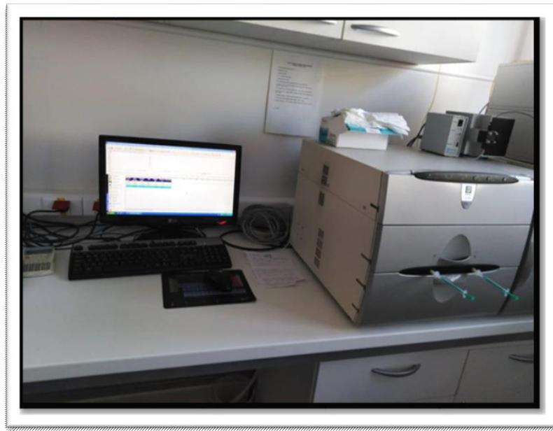
Slika 13 . Ionski kromatograf ICS 3000 Dionex/ HPLC Shimadzu.
