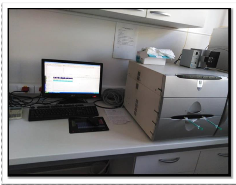
Slika 13 . Ionski kromatograf ICS 3000 Dionex/ HPLC Shimadzu.
