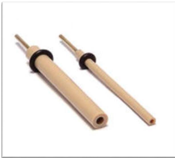
Slika 17. Elektroda od staklastog ugljika [38].
