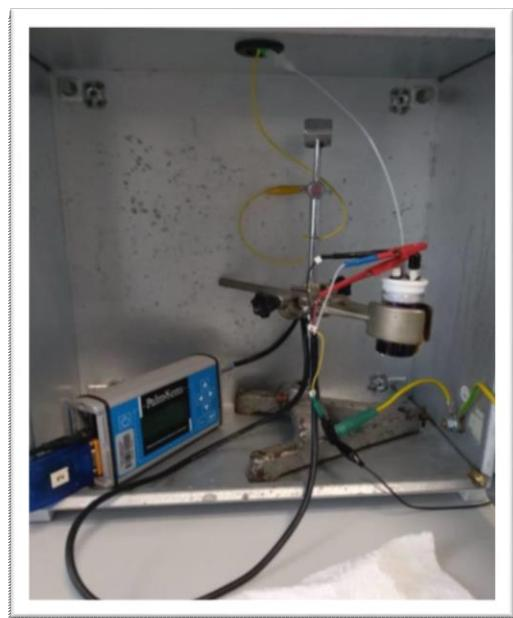
**Slika 16.** Elektrokemijska čelija s troelektrodnim sustavom.
