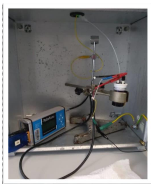
Slika 16. Elektrokemijska ćelija s troelektrodnim sustavom.
