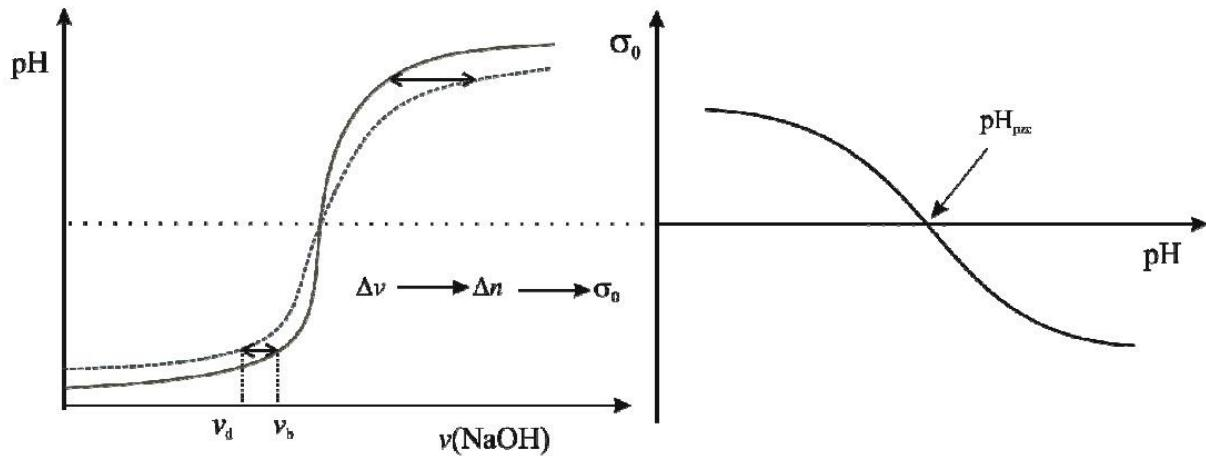
Slika 10. Shematski prikaz potenciometrijske titracije (lijevo): titracija slijepе probe (puna linija), titracija koloidne suspenzije (isprekidana linija); Shematski prikaz površinskog naboja kao funkcije pH (desno) [14].
