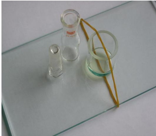
Slika 6: Prikaz izrade membrane ionsko selektivne elektrode
