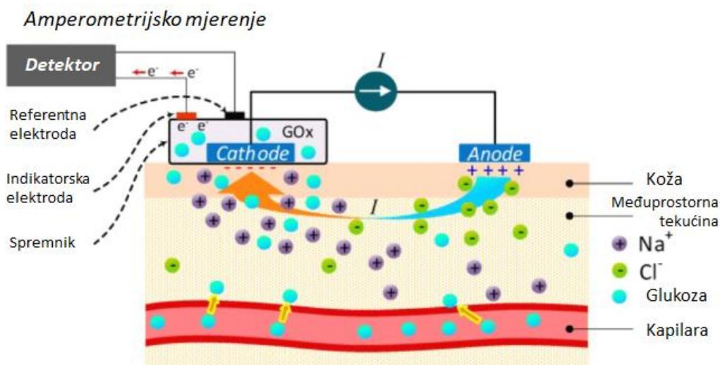
Slika 6. Princip obrnute iontoporeze za mjerjenje glukoze. Izvor: [8]
