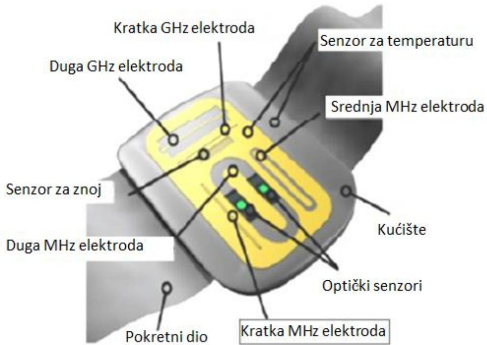
Slika 8. Shematsku ilustraciju multisenzornog sustava. Izvor: [12]
