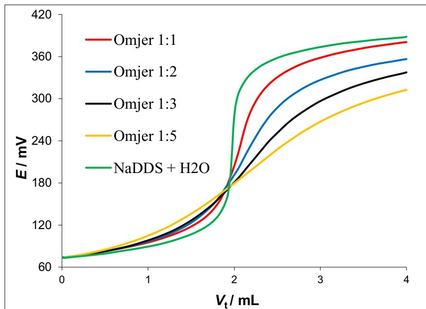
**Slika 8.** Prikaz titracijskih krivulja NaDDS-a,  $c = 4 \times 10^{-3}$  M, s CPC-om,  $c = 4 \times 10^{-3}$  M, uz dodatak Genapola T 110,  $c = 1 \times 10^{-2}$  M, u različitim molarnim omjerima u odnosu na NaDDS
