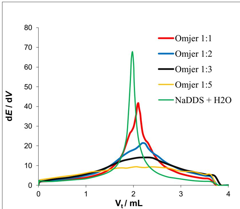
**Slika 11.** Prikaz prvih derivacija titracijskih krivulja NaDDS-a,  $c = 4 \times 10^{-3}$  M, s CPC-om,  $c = 4 \times 10^{-3}$  M, uz dodatak Genapolu T 150,  $c = 1 \times 10^{-2}$  M, u različitim molarnim omjerima u odnosu na NaDDS
