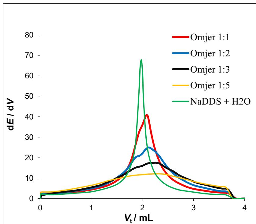
**Slika 9.** Prikaz prvih derivacija titracijskih krivulja NaDDS-a,  $c = 4 \times 10^{-3}$  M, s CPC-om,  $c = 4 \times 10^{-3}$  M, uz dodatak Genapola T110,  $c = 1 \times 10^{-2}$  M, u različitim molarnim omjerima u odnosu na NaDDS
