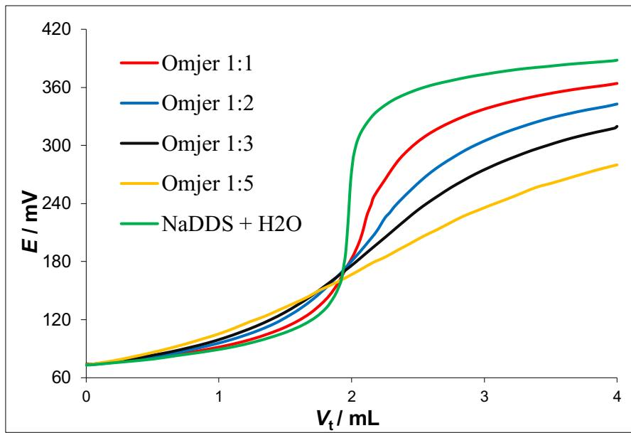
**Slika 10.** Prikaz titracijskih krivulja NaDDS-a,  $c = 4 \times 10^{-3}$  M, s CPC-om,  $c = 4 \times 10^{-3}$  M, uz dodatak Genapolu T 150,  $c = 1 \times 10^{-2}$  M, u različitim molarnim omjerima u odnosu na NaDDS
