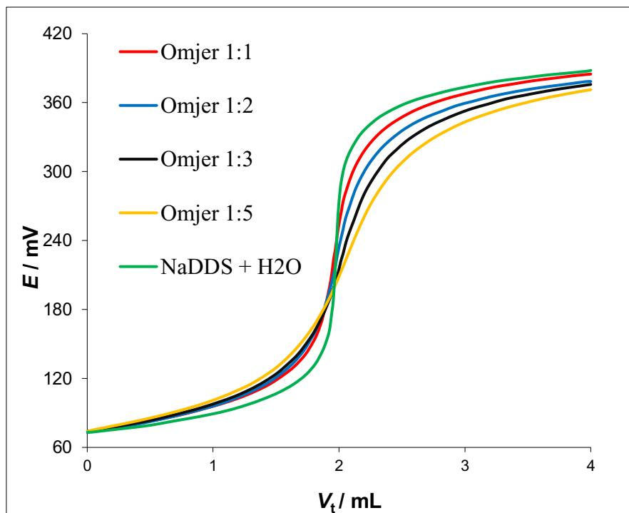
**Slika 6.** Prikaz titracijskih krivulja NaDDS-a,  $c = 4 \times 10^{-3}$  M, s CPC-om,  $c = 4 \times 10^{-3}$  M, uz dodatak Genapola T 080,  $c = 1 \times 10^{-2}$  M, u različitim molarnim omjerima u odnosu na NaDDS
