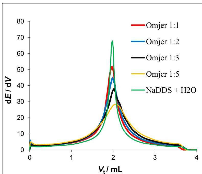
**Slika 7.** Prikaz prvih derivacija titracijskih krivulja NaDDS-a,  $c = 4 \times 10^{-3}$  M, s CPC-om,  $c = 4 \times 10^{-3}$  M, uz dodatak Genapola T 080,  $c = 1 \times 10^{-2}$  M, u različitim molarnim omjerima u odnosu na NaDDS
