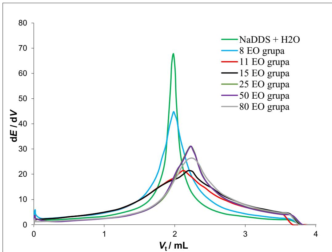
*Slika 5.* Prikaz prvih derivacija titracijskih krivulja dobivenih ispitivanjem utjecaja broja EO grupa Genapola T 080, Genapola T 110, Genapola T 150, Genapola T 250, Genapola T 500 i Genapola T 800 na titraciju anionskog tenzida NaDDS pri omjeru NaDDS :
