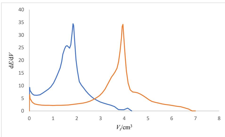
Slika 12. Derivacijske krivulje dobivene pri potenciometrijskoj titraciji otopine univerzalnog tekućeg sredstva za čišćenje otopinom CPC-a ( $c = 4 \times 10^{-3} \text{ mol}/\text{dm}^3$ ) i uz poznati dodatak NaDDS-a (— sredstvo za čišćenje, — sredstvo za čišćenje + 2  $\text{cm}^3$  NaDDS)
