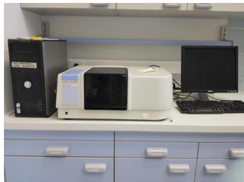
*Slika 11. Shimadzu FTIR 8400S spektrometar*
