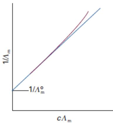
Slika 14. Grafičko određivanje granične molarne provodnosti otopine jakog elektrolita ekstrapolacijom na nulu koncentraciju. [10]
