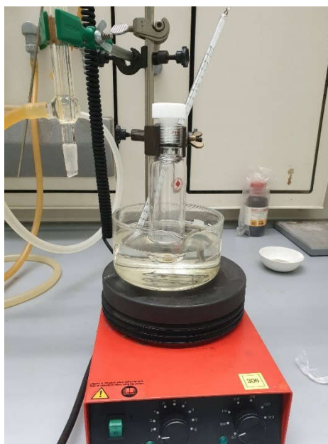
Slika 10. Aparatura za pripravu spoja 4 Wolff-Kishnerovom redukcijom spoja 2
