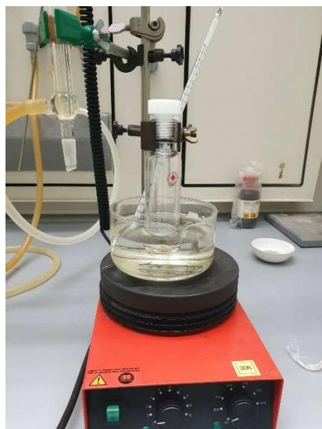
**Slika 10.** Aparatura za pripravu spoja **4** Wolff-Kishnerovom redukcijom spoja **2**
