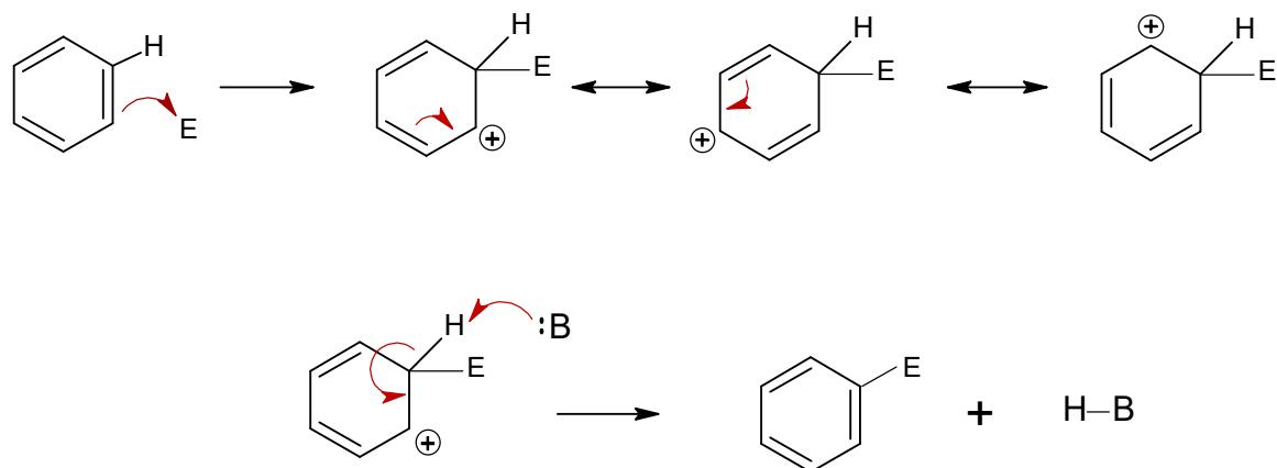
**Shema 1.** Općeniti mehanizam elektrofilne aromatske supstitucije [3]
