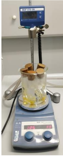
Slika 18.: Vodena kupelj s uzorcima
