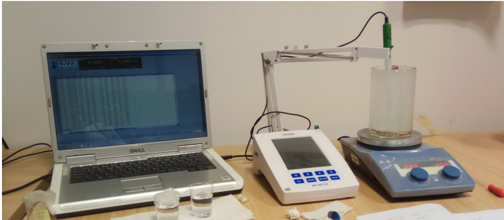
Slika 12. Slika aparature korištene za sintezu kalcijeva oksalata.
