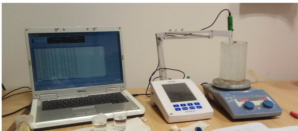
Slika 11. Slika aparature za određivanje pH vrijednosti ispitivanih otopina.
