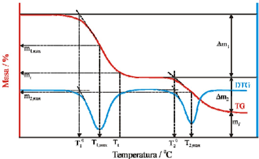
**Slika 8.** Opći oblik termograma s karakterističnim točkama.
