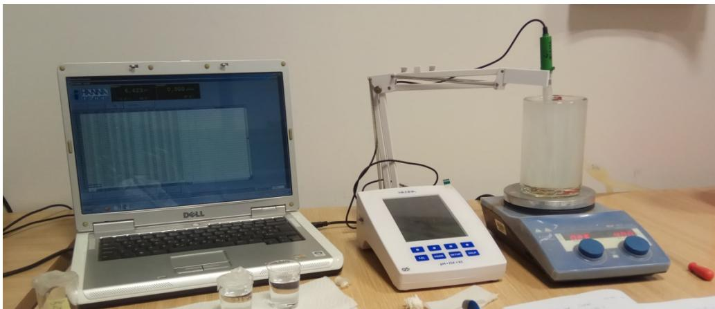
**Slika 12.** Slika aparature korištene za sintezu kalcijeva oksalata.
