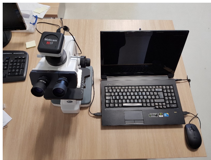
Slika 14. Svjetlosni mikroskop s digitalnom kamerom priključen na prijenosno računalo.
