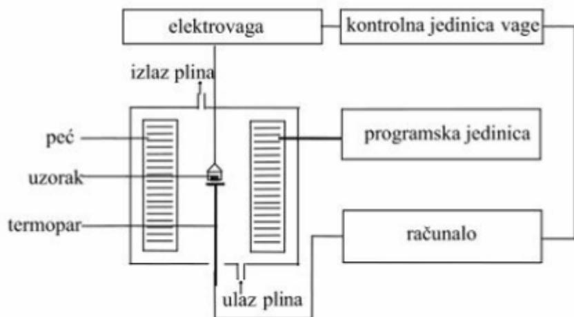
**Slika 7.** Shema termogravimetrijskog instrumenta.
