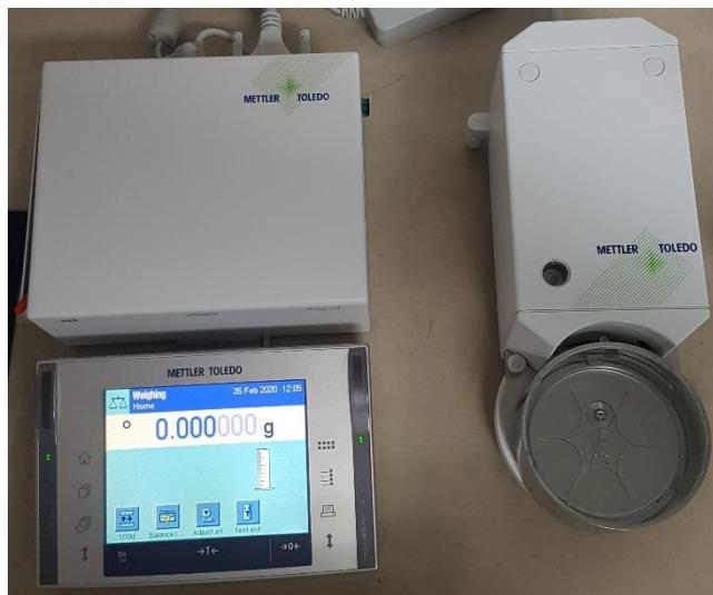
Slika 14. *Mettler Toledo* vaga sa osjetljivošću od  $10^{-6}$  g.
