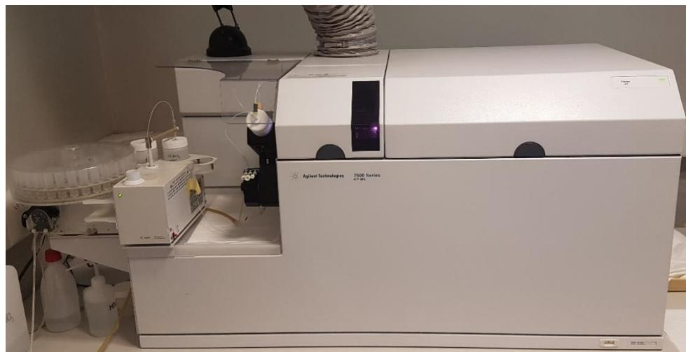
Slika 16. Maseni spektrometar s induktivno spregnutom plazmom
