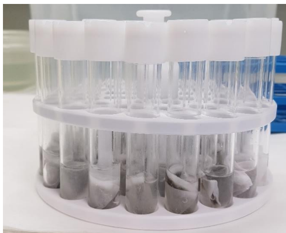
Slika 17. Uzorci u otopini koncentrirane dušične kiseline.
