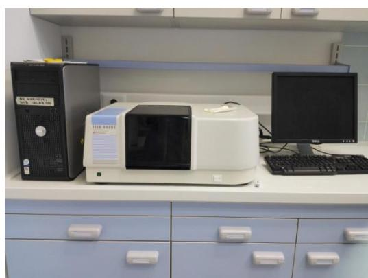
*Slika 14. Shimadzu FTIR 8400S spektrometar*
