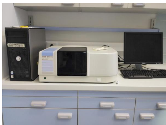
Slika 14. Shimadzu FTIR 8400S spektrometar
