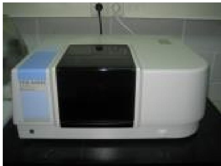
**Slika 18.** Spektrometar korišten za snimanje infracrvenih spektara.
