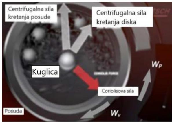
**Slika 11.** Sile unutar reakcijske posude planetarnog kuglično mlinja [24].
