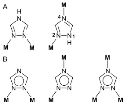
Slika 32: Koordinacijski načini vezanja (A) 1,2,4-triazola( $\mu\text{-}1,2$  i  $\mu\text{-}2,4$ ) i (B) 1,2,4-triazolata ( $\mu\text{-}1,2$ ,  $\mu\text{-}1,4$  i  $\mu\text{-}1,2,4$ ). M simbolizira metalni ion
