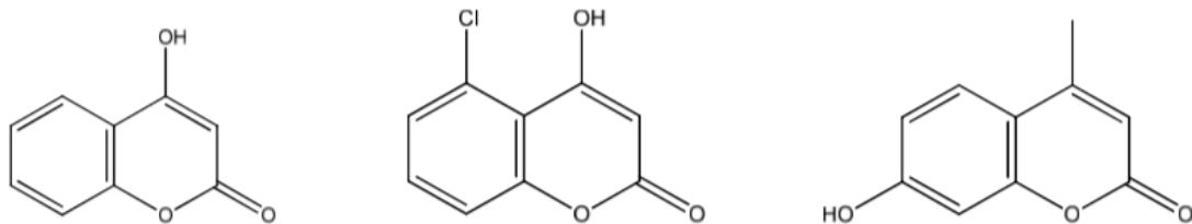
Slika 15: 4-hidroksikumarin, 4-hidroksi-5-klorkumarin i 7-hidroksi-4-metilkumarin
