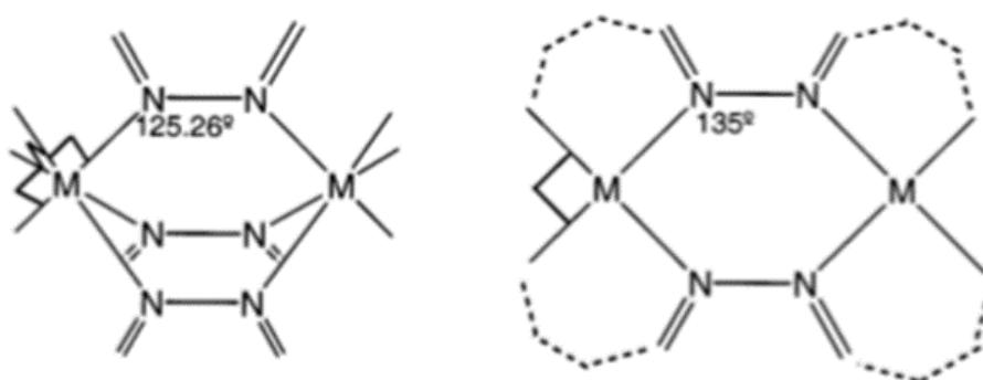
Slika 34: Trostruko(ljevo) i dvostruko(desno) premoštenje između dva atoma metala.[33]
