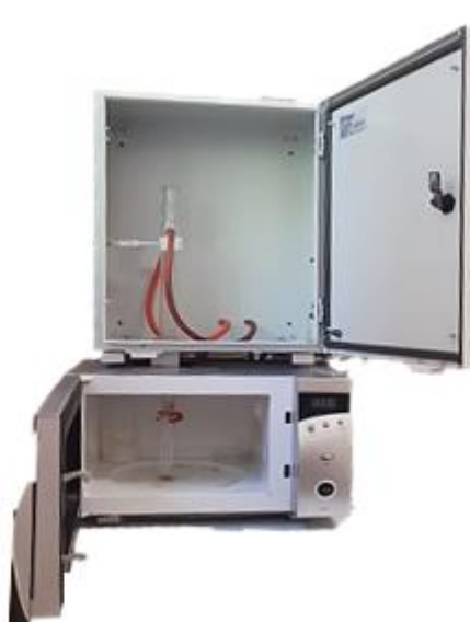
Slika 23. Modificirana kućna mikrovalna pećnica marke Electrolux EMS 2105.
